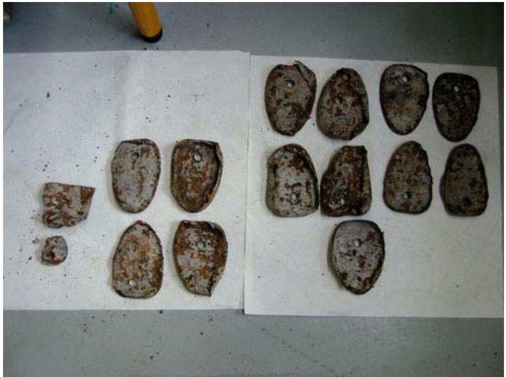
Figur 4.15 Dåser i klasse 1 efter lagring og passage af sorteringstromle
