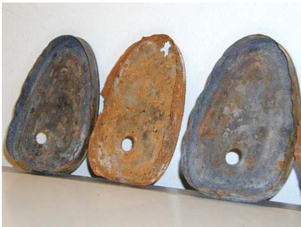
Figur 4.14 Klasse 1-dåse (i midten) lagret i slaggebuske sammenlignet med dåser udtaget umiddelbart efter forbrænding
