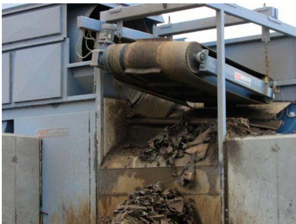
Figur 4.2 Overbåndsmagnet til fraseparering af jern fra overstørrelsesfraktion
