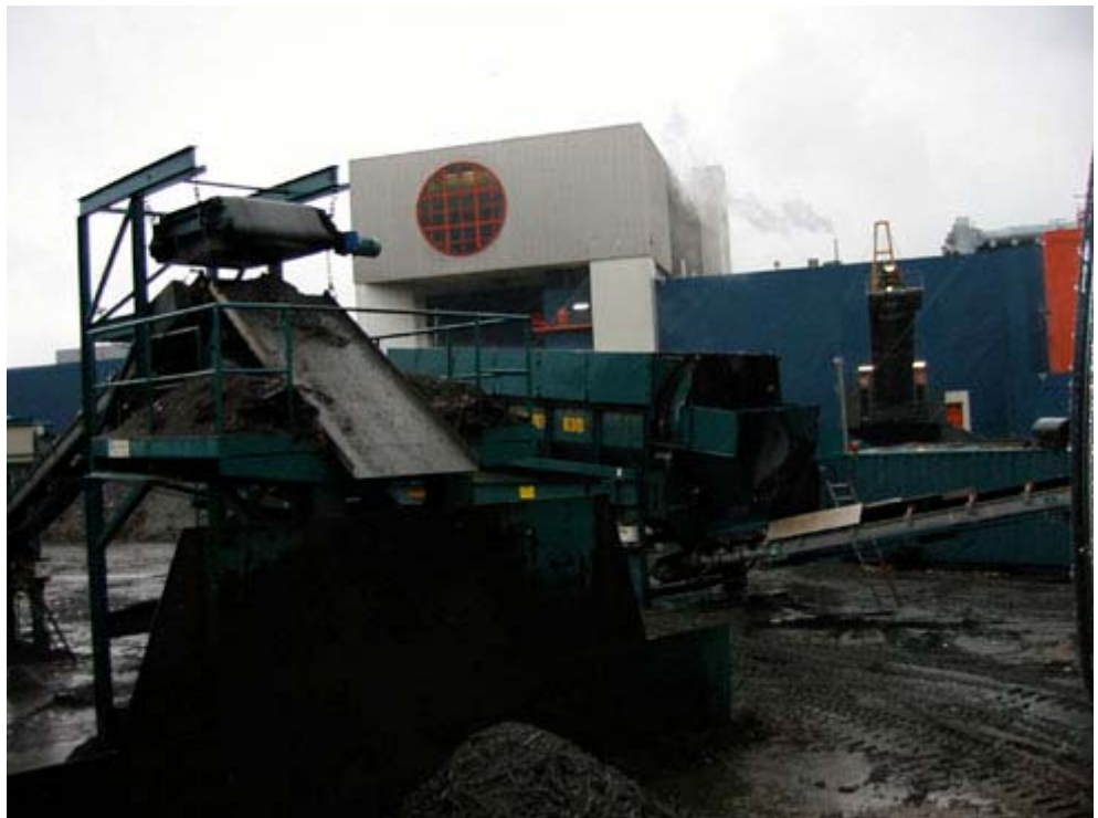
Figur 4.9 Sortéromle og magnetseparation af understørrelsesfraktion
