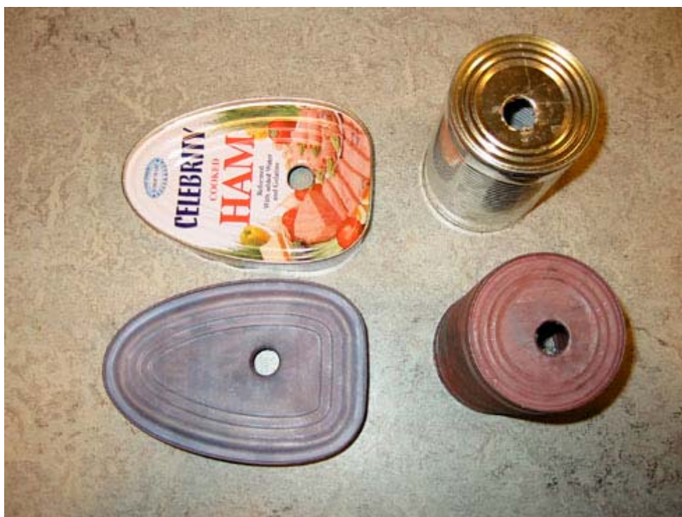
Figur 3.3 Dåser før foraskningsforsøg og efter foraskningsforsøg og fjernelse af oxidlag
