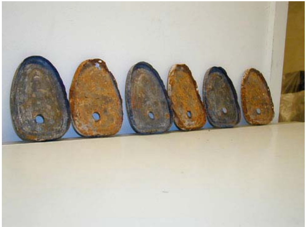
Figur 4.13 Klasse 1-dåser lagret i slaggebunke sammenlignet med dåser udtaget umiddelbart efter forbrænding
