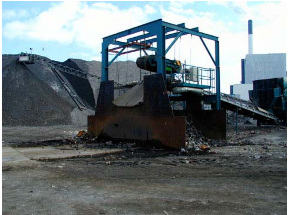
Figur 4.12 Magnetsortering af overstørrelsesfraktion
