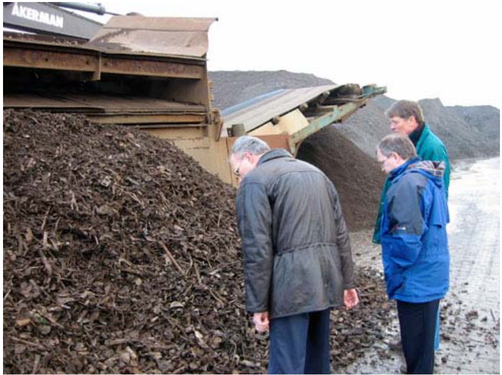
Figur 4.7 Rystesold der fraseparerer jern fra understørrelsesfraktion
