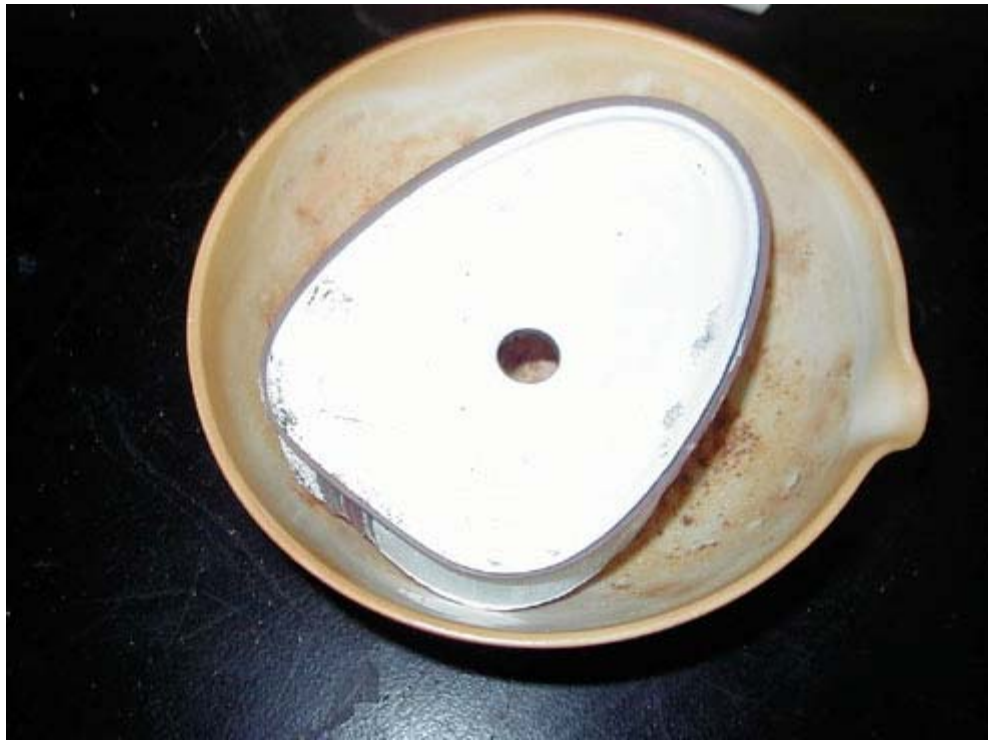
Figur 3.1 Oval dåse efter foraskning 550°C
