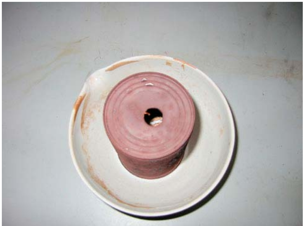
Figur 3.2 Tomatdåse efter foraskning 550°C
