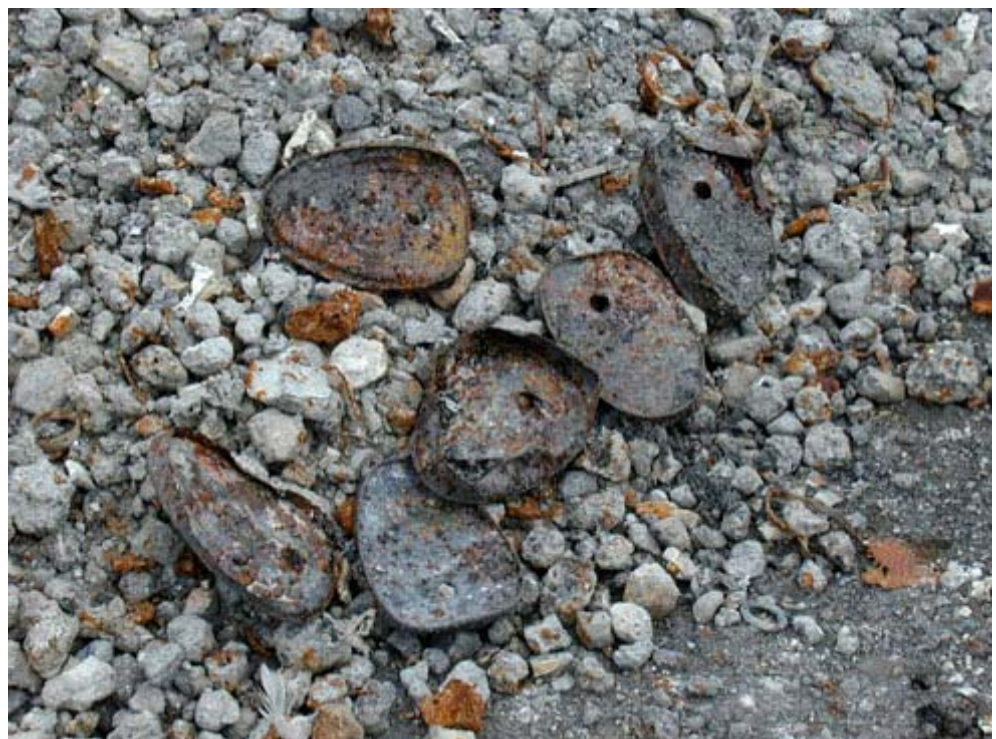
Figur 4.11 Dåser fra lagring i slaggebunke
