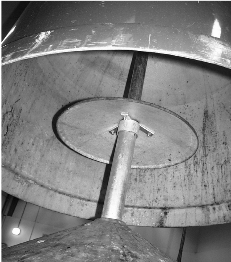
Figur 23 Flaskebremse i kube
