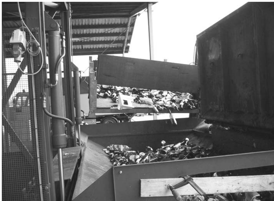
Figur 9 Aflæsning af glas fra rammer til transportbånd
