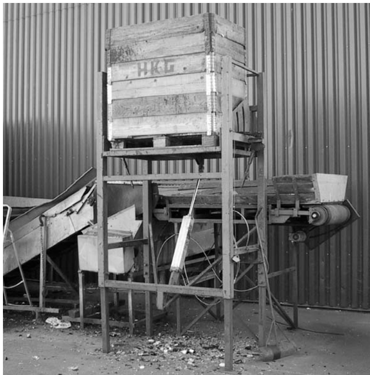
Figur 17 Tømning af palletterammer
