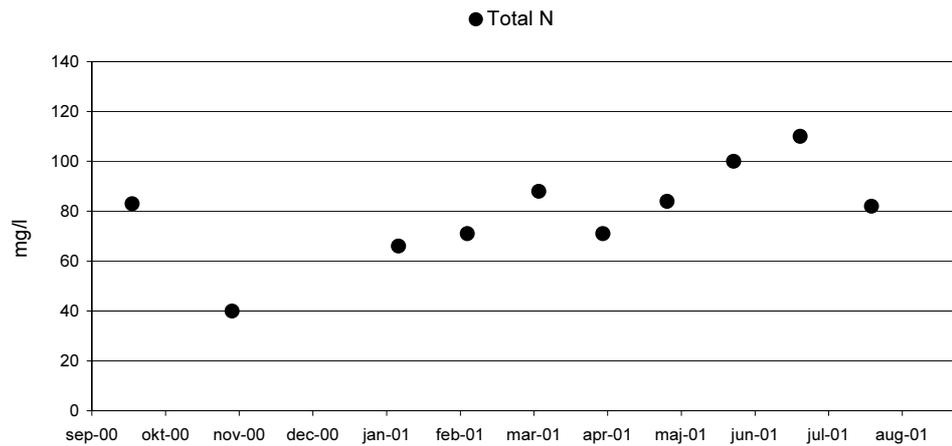
FIGUR 13: KONCENTRATION AF TOTAL-N I UDLØB FRA BUNDFÆLDNINGSTANKEN.
