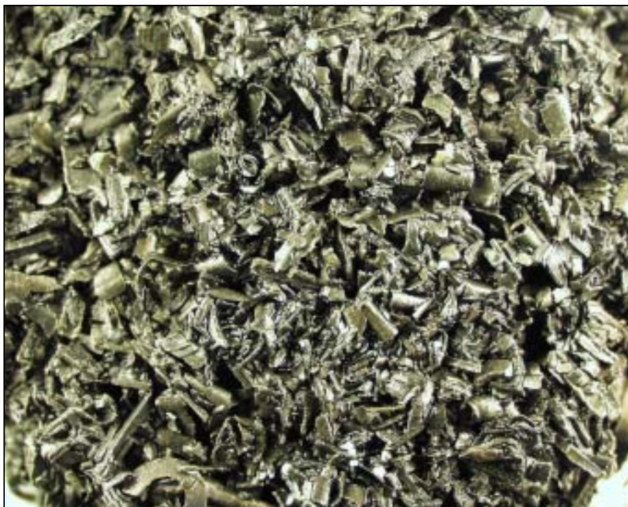
Figur 13: Foto af jernspåner boring GP3 1,6-2,25 m under terræn
