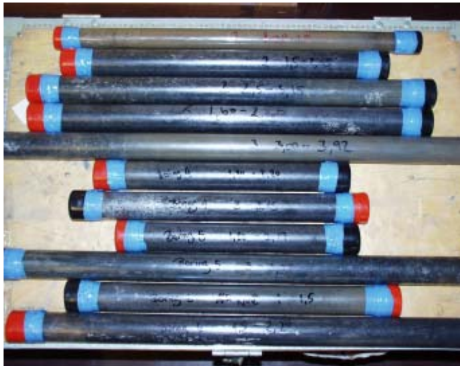
Figur 12: Der blev udtaget 11 boreprøver fra forskellige positioner i den reaktive væg
