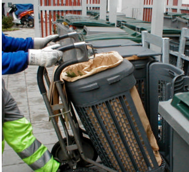
Foto 3.5: Bates Combi System ved husstande med fælles opsamlingsmateriel
