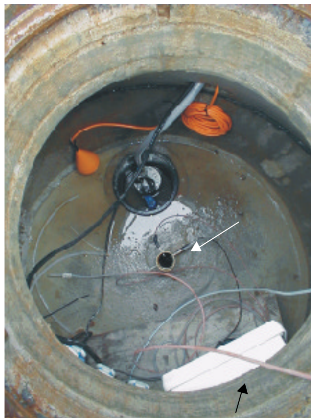
Figur 4.3 Moniteringsbrønd med GAC-enhed fjernet. Prins Valdemars Alle 14, Allerød.
