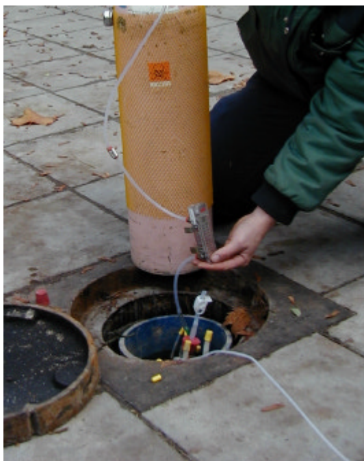
Figur 4.10 Dosering af tracergas (CO) til observationspunkt, Møllevvej 12, Askov.
