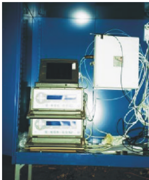
Figur 4.9 Måleskab med datalogger system og 2 stk. Innova 1312 gasmålere til on-line måling af PCE fra to filtre i boring PV4, Møllevvej 12, Askov.
