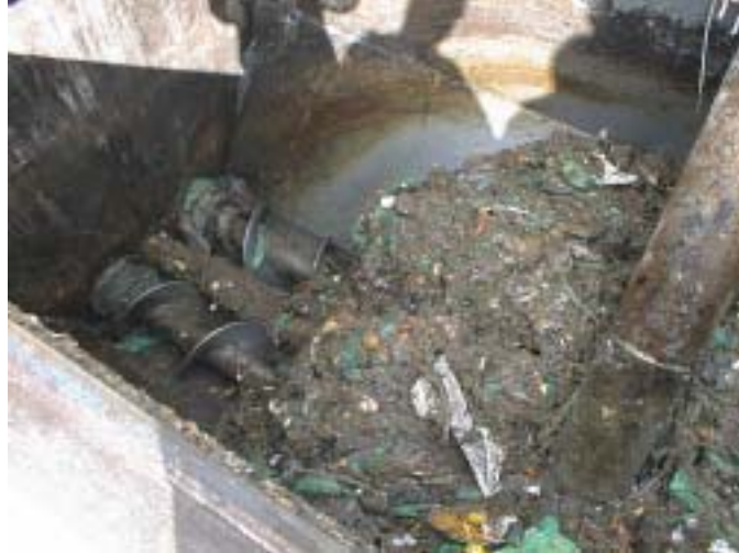
Figur 3.1.3: Affaldsgrav på Vaarst-Fjellerad Biogasanlæg
