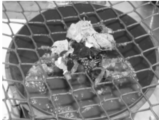
Figur 4.3.3: Plasttilbageholdelse på sigte med maskevidde 25 mm efter sigtning af 0,4 l biomasse med højt plastindhold
