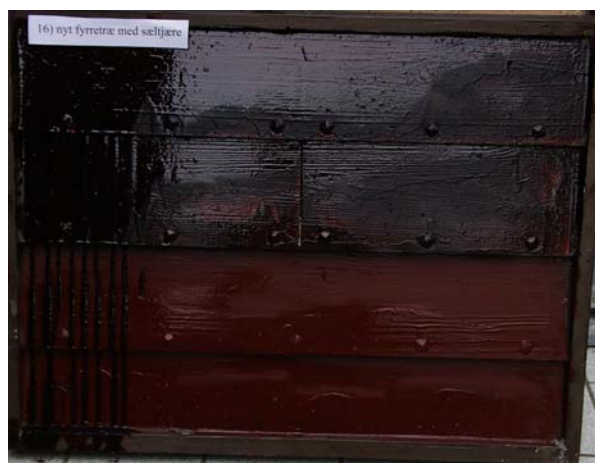
Prøveplade nr. 16 Nyt fyrretræ, behandlet med sæltjære. Klinkbygget
