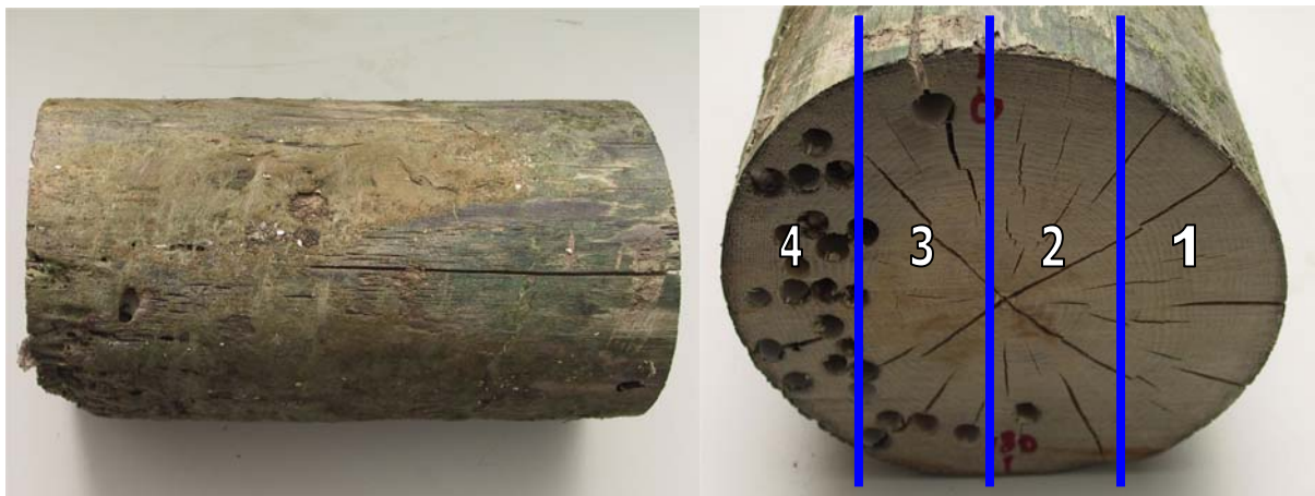
Figur 1: Pæl med pæleormsangreb. Udsæringen i fire emner er vist til højre.
