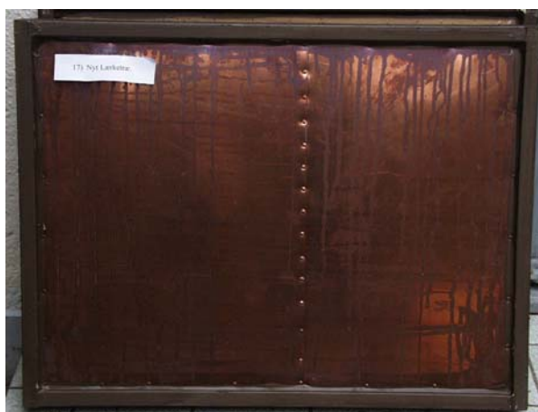
Prøveplade nr. 17 Nyt lærke, med kobber-forhudning.
