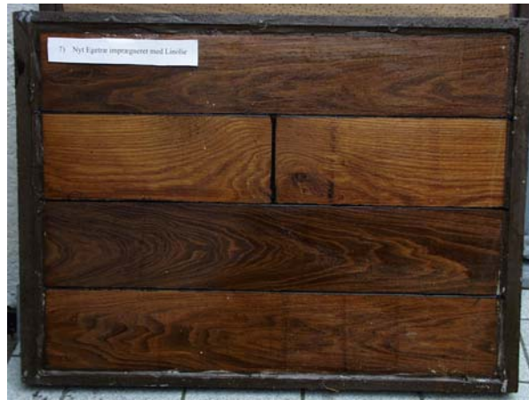
Prøveplade nr. 7 Nyt egetræ behandlet med linolie. Kravelbygget
