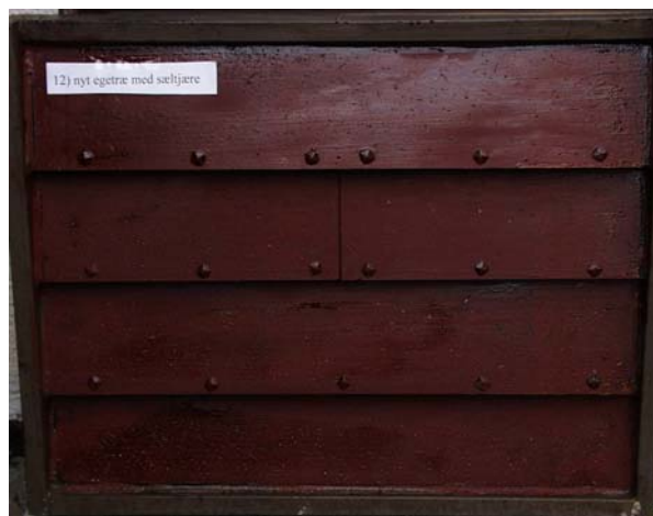
Prøveplade nr. 12 Nyt egetræ, behandlet med sæltjære. Klinkbygget
