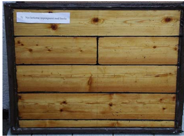
Prøveplade nr. 5 Nyt lærketræ behandlet med linolie. Kravelbygget.
