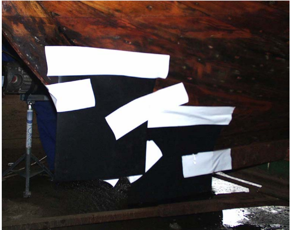
Figur 42. Bagbord side af stævn med folieplader påhæftet skibet. (pladerne er sorte, tapen er hvid)
