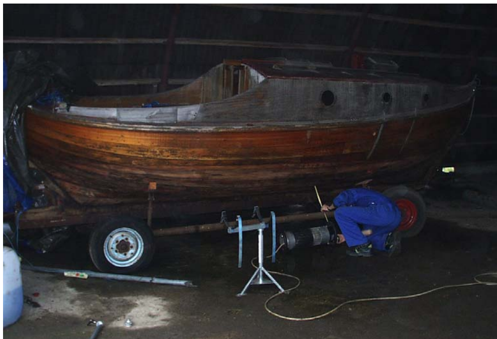
Figur 39. Placering af strålekanon på ydersiden, samt opmåling af korrekt afstand.
