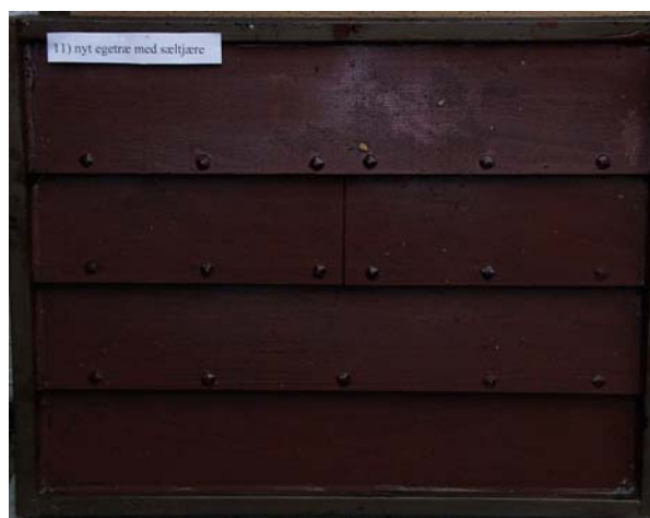
Prøveplade nr. 11 Nyt egetræ, behandlet med sæltjære. Klinkbygget
