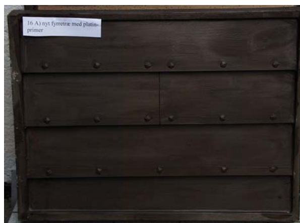
Prøveplade nr. 16A Nyt fyrretræ, behandlet med platinprimer. Klinkbygget.
