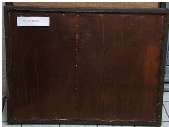
Prøveplade nr. 18 Nyt egetræ, med kobber-forhudning.
