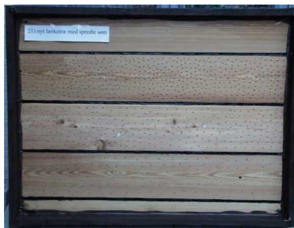
Prøveplade nr. 21 Nyt lærketræ, behandlet med spredte søm. Kravelbygget.
