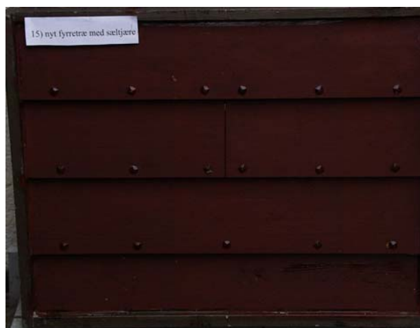
Prøveplade nr. 15 Nyt fyrretræ, behandlet med sæltjære. Klinkbygget.
