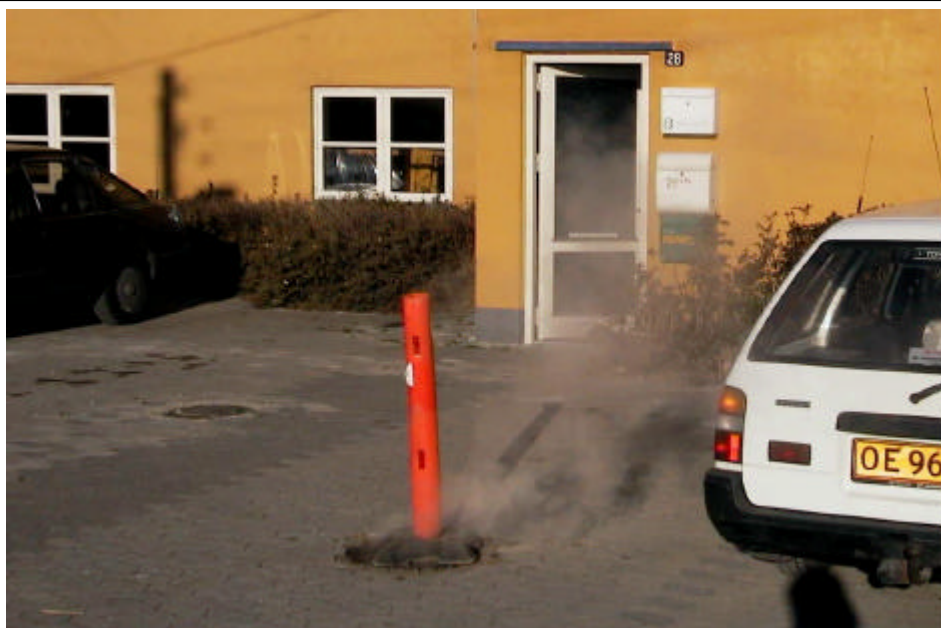
Figur 3.2 Dampgennembrud fra utæt boring (uden vakuum). Brønddækslet fra dampinjektionsboringen ses i baggrunden til venstre.
