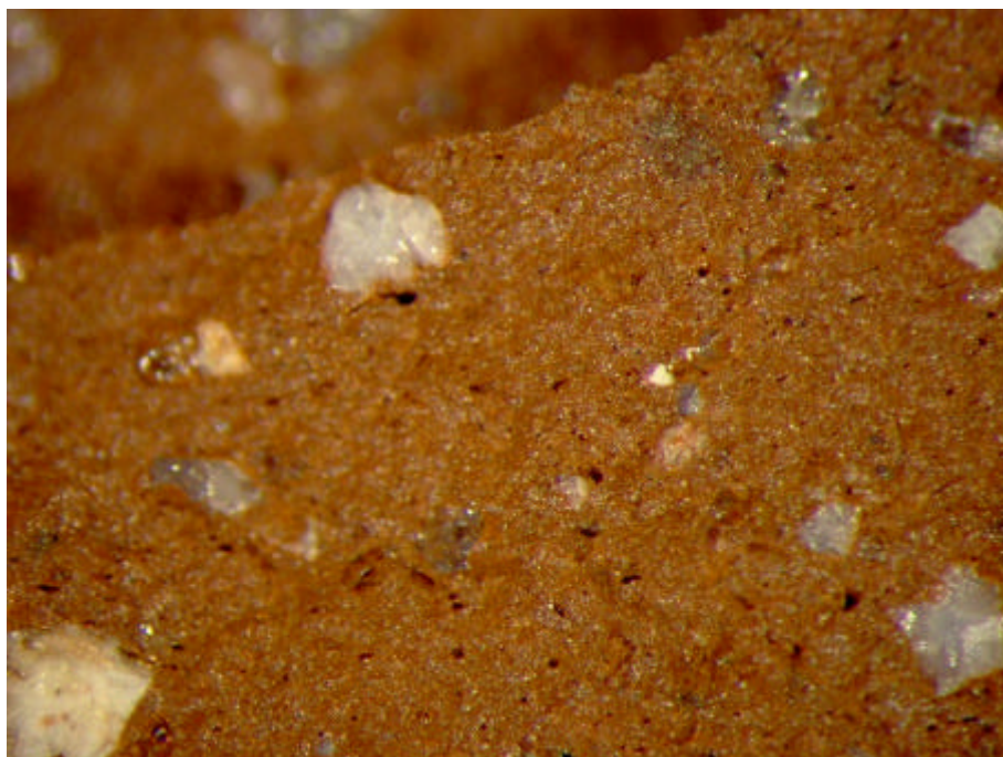
Figur G.16. Prøve B Hammershøj – glasmel 1050°C Brudflade – Forstørrelse 24x
