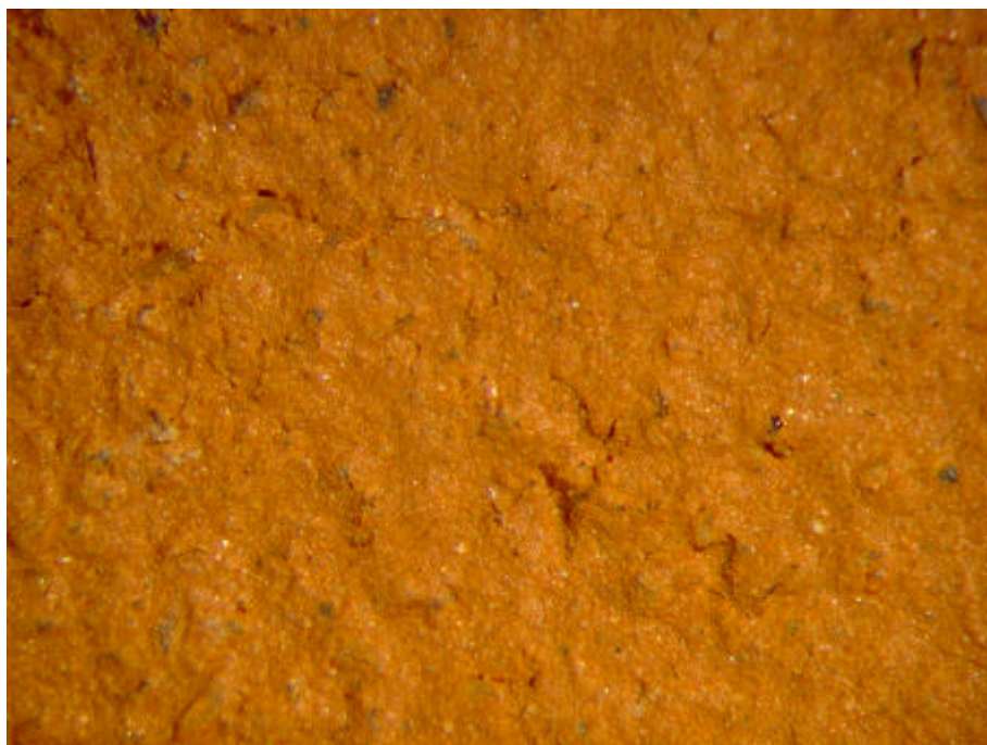
Figur G.43. Prøve F Sønderkov – reference 1000°C Synsflade – Forstørrelse 24x
