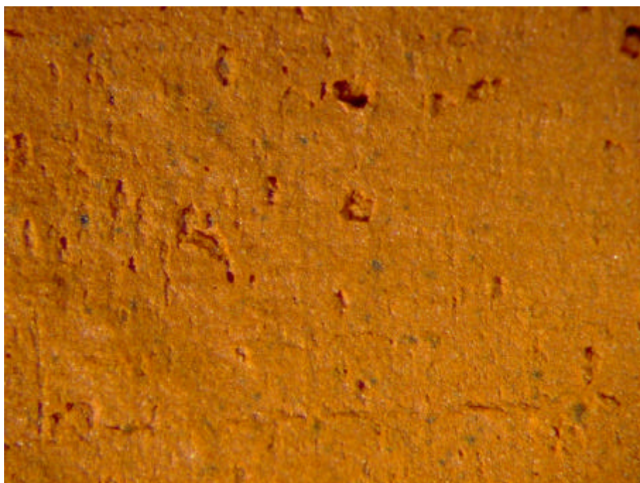
Figur G.17. Prøve C Hammershøj – reference 975°C Synsflade – Forstørrelse 24x
