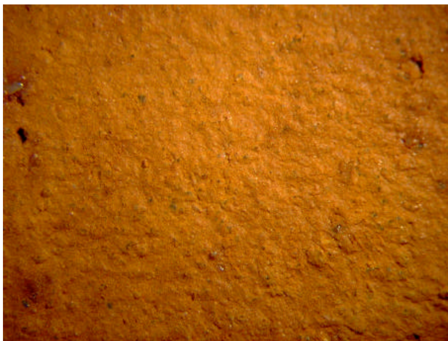
Figur G.33. Prøve E Sønderkov – glasmel 975°C Synsflade – Forstørrelse 24x
