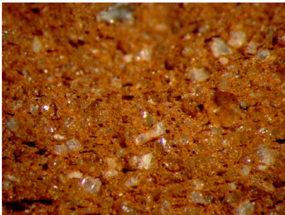
Figur G.40. Prøve E Sønderkov – glasmel 1050°C Brudflade – Forstørrelse 24x
