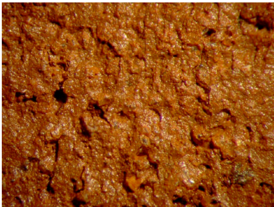
Figur G.39. Prøve E Sønderkov – glasmel 1050°C Synsflade – Forstørrelse 24x
