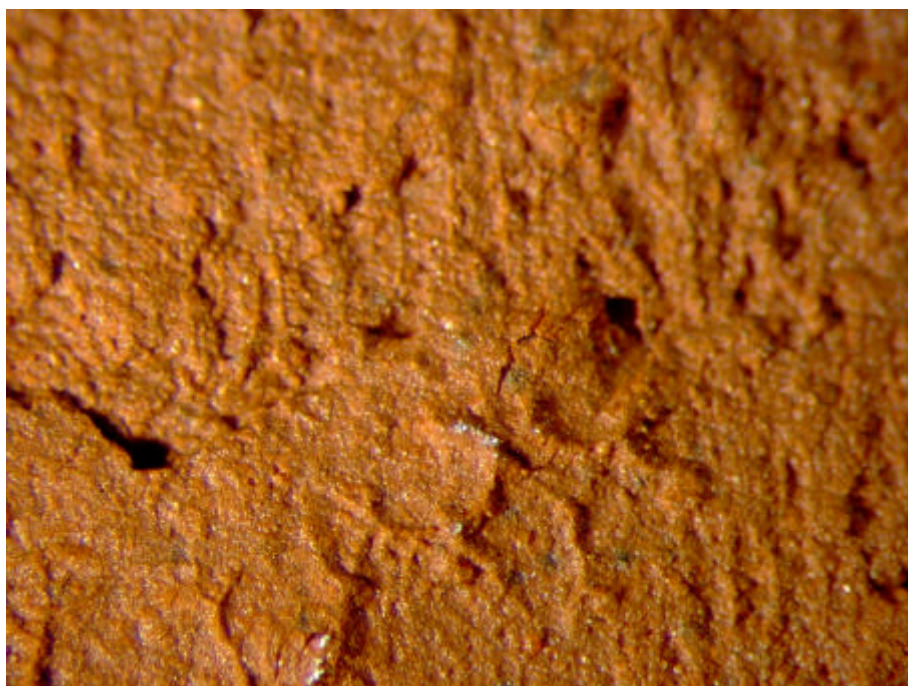
Figur G.13. Prøve B Hammershøj – glasmel 1025°C Synsflade – Forstørrelse 24x
