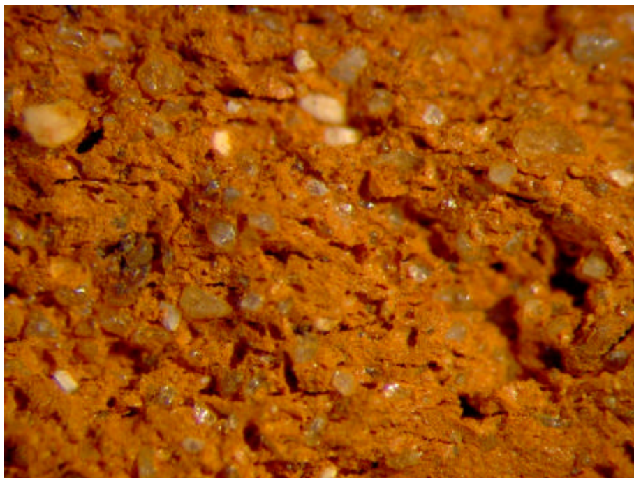
Figur G.44. Prøve F Sønderkov – reference 1000°C Brudflade – Forstørrelse 24x
