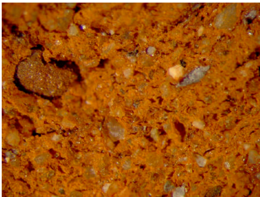
Figur G.28. Prøve D Sønderskov – glassand 1000°C Brudflade – Forstørrelse 24x
