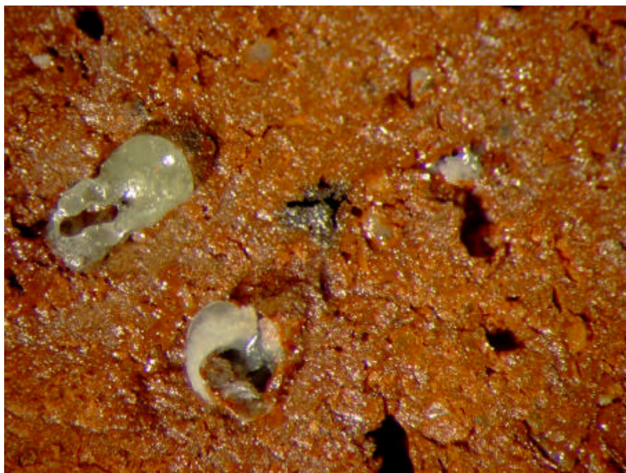
Figur G.31. Prøve D Sønderkov – glassand 1050°C Synsflade – Forstørrelse 24x
