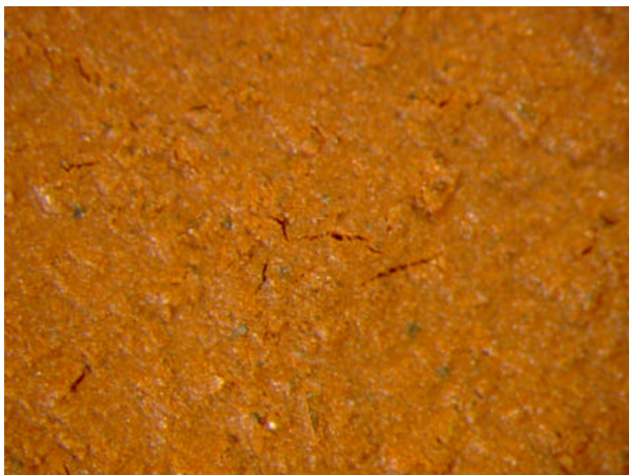
Figur G.45. Prøve F Sønderskov – reference 1025°C Synsflade – Forstørrelse 24x
