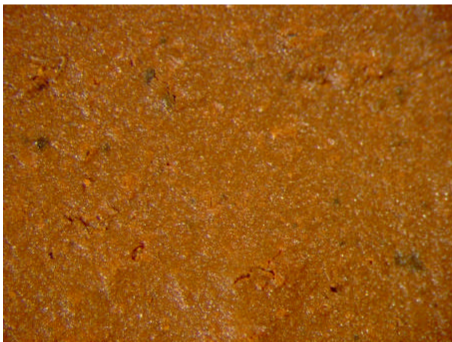
Figur G.21. Prøve C Hammershøj – reference 1025°C Synsflade – Forstørrelse 24x
