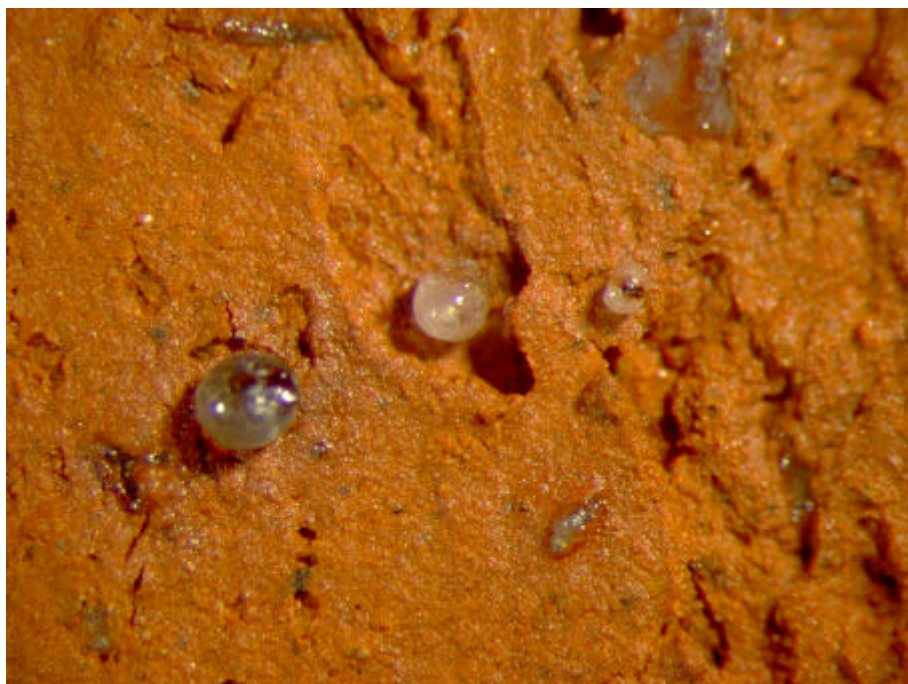
Figur G.3. Prøve A Hammershøj – glassand 1000°C Synsflade – Forstørrelse 24x
