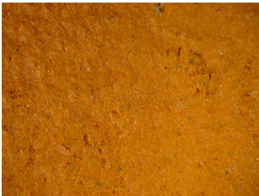
Figur G.41. Prøve F Sønderkov – reference 975°C Synsflade – Forstørrelse 24x
