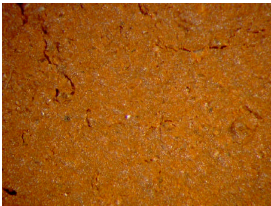
Figur G.47. Prøve F Sønderskov - reference 1050°C Synsflade – Forstørrelse 24x
