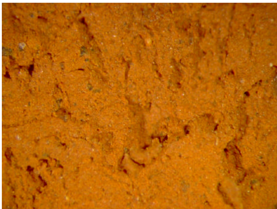
Figur G.9. Prøve B Hammershøj – glasmel 975°C Synsflade – Forstørrelse 24x
