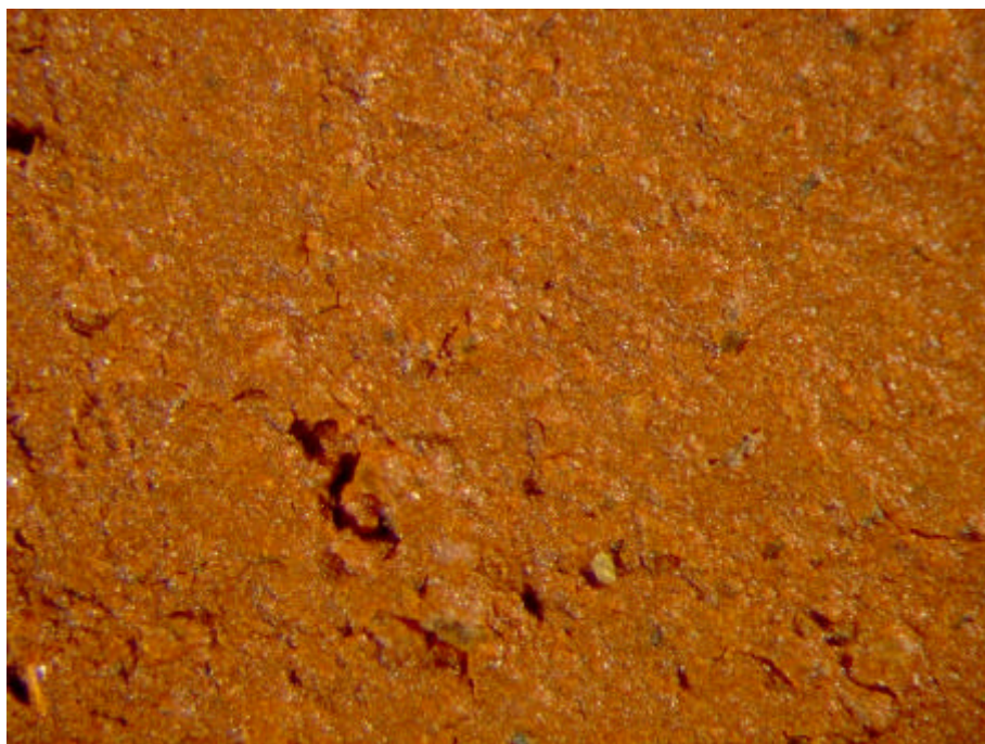
Figur G.35. Prøve E Sønderkov – glasmel 1000°C Synsflade – Forstørrelse 24x
