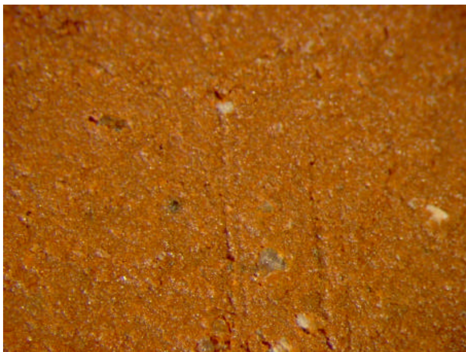
Figur G.37. Prøve E Sønderkov – glasmel 1025°C Synsflade – Forstørrelse 24x
