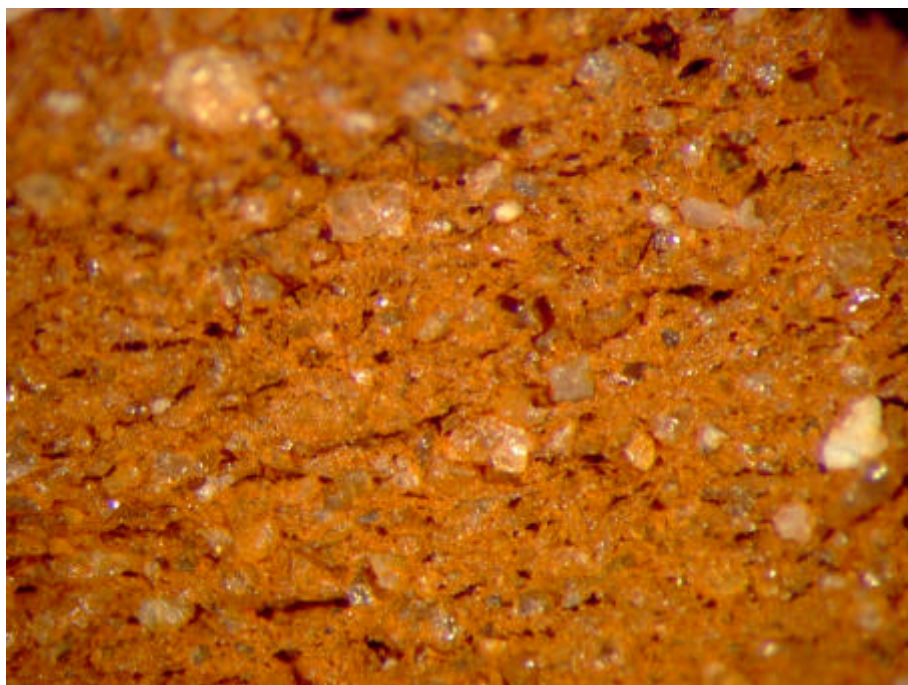
Figur G.48. Prøve F Sønderskov - reference 1050°C Brudflade – Forstørrelse 24x
