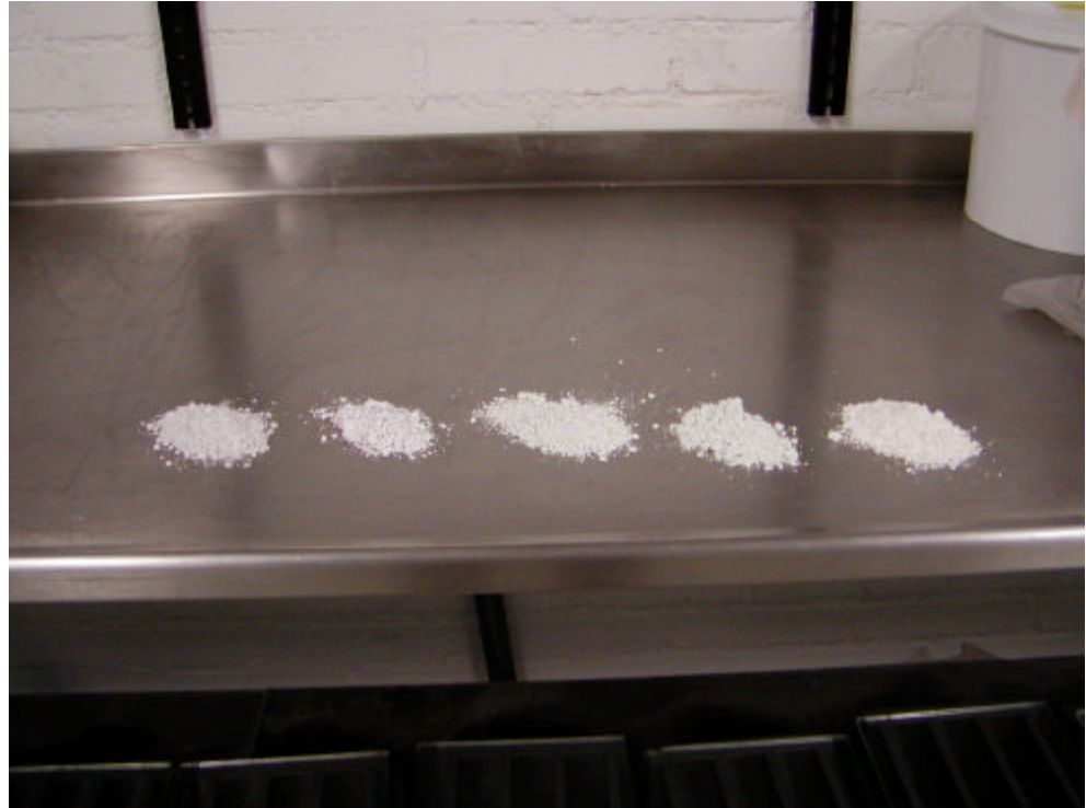
Figur 3.1: De fem glasfillere K350, K500, G500 og G350 samt Aalborg White ® cement
