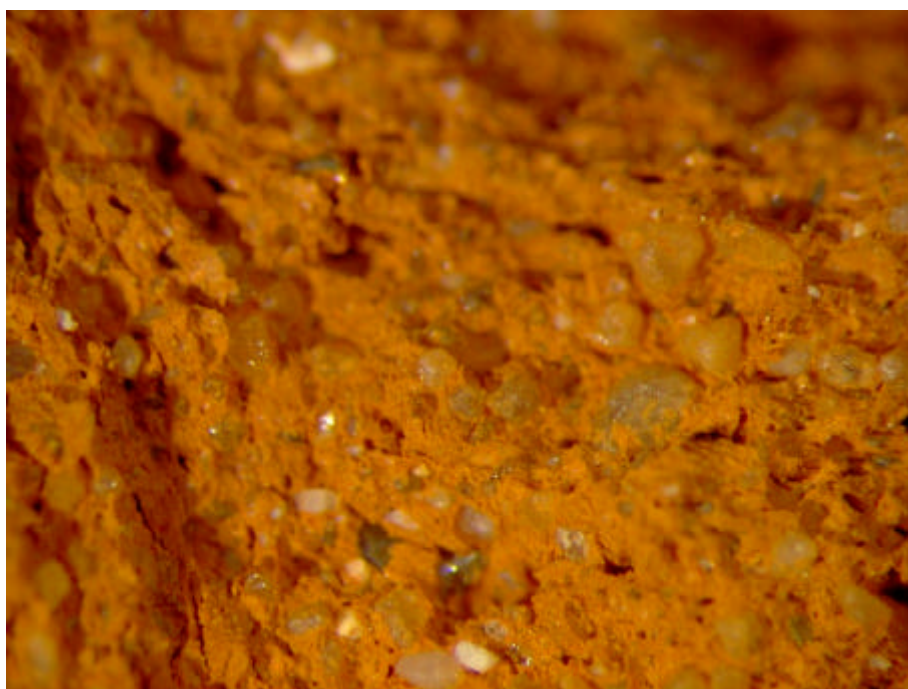
Figur G.42. Prøve F Sønderkov – reference 975°C Brudflade – Forstørrelse 24x
