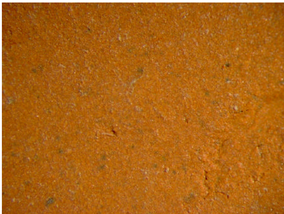
Figur G.11 Prøve B Hammershøj – glasmel 1000°C Synsflade – Forstørrelse 24x
