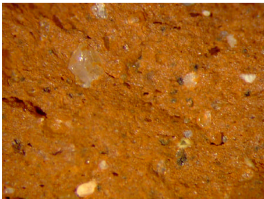
Figur G.20. Prøve C Hammershøj – reference 1000°C Brudflade – Forstørrelse 24x
