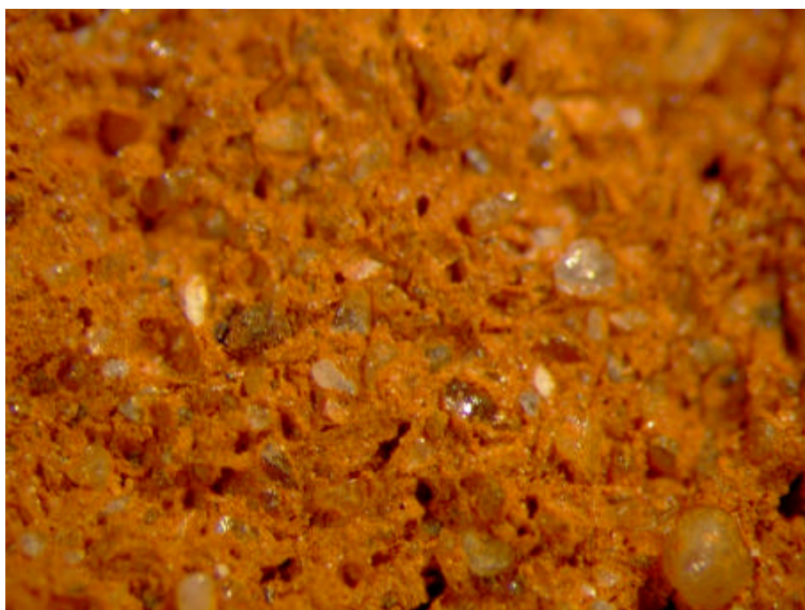
Figur G.34. Prøve E Sønderkov – glasmel 975°C Brudflade – Forstørrelse 24x
