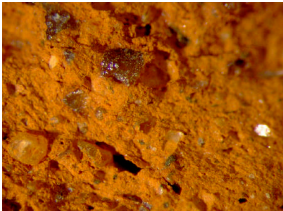
Figur G.2. Prøve A Hammershøj – glassand 975°C Brudflade – Forstørrelse 24x
