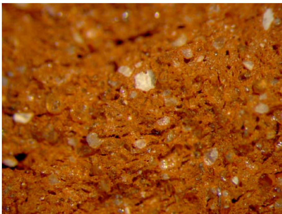
Figur G.38. Prøve E Sønderkov – glasmel 1025°C Brudflade – Forstørrelse 24x
