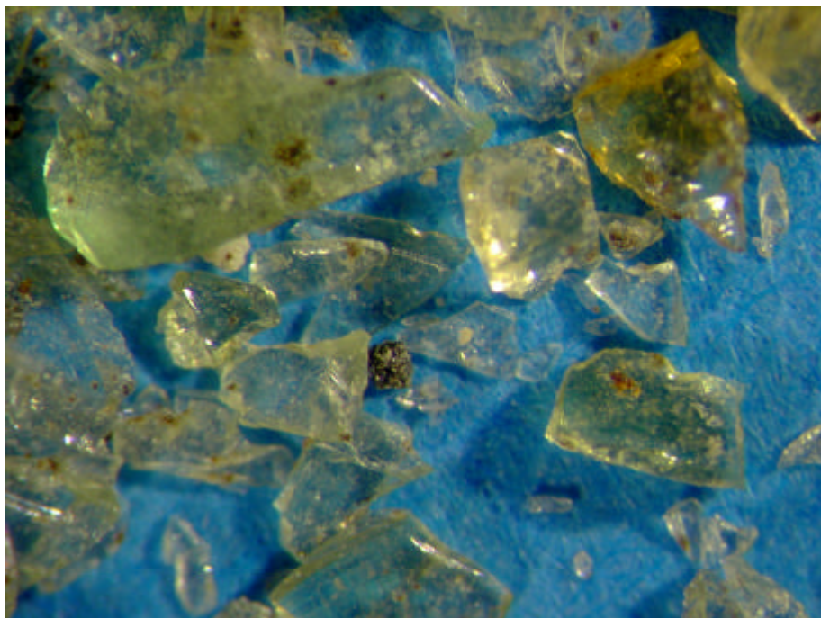
Figur 2.2: Glassand, Fraktion <1 mm. Forstørrelse 24×
