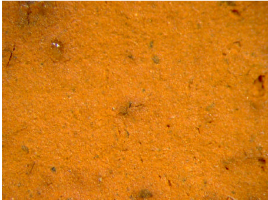
Figur G.1 Prøve A Hammershøj - glassand 975°C. Synsflade – Forstørrelse 24x
