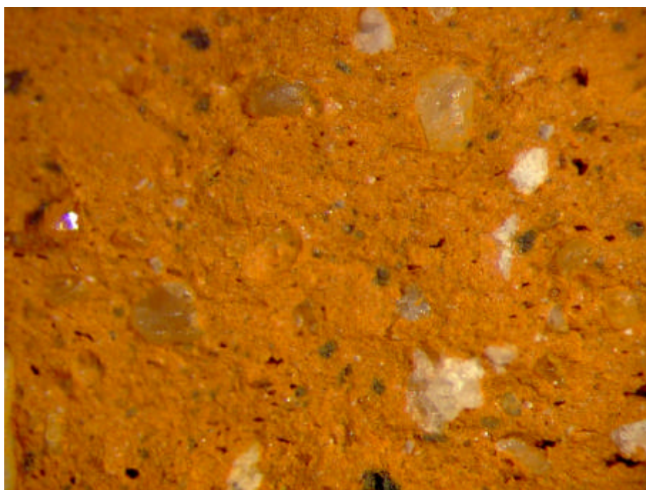
Figur G.18. Prøve C Hammershøj – reference 975°C Brudflade – Forstørrelse 24x
