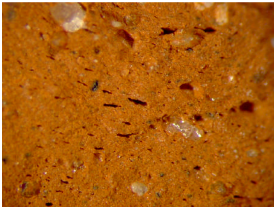
Figur G.12. Prøve B Hammershøj – glasmel 1000°C Brudflade – Forstørrelse 24x
