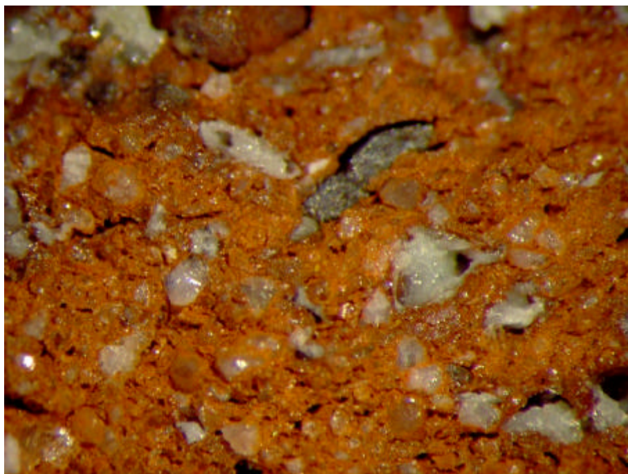
Figur G.32. Prøve D Sønderkov – glassand 1050°C Brudflade – Forstørrelse 24x
