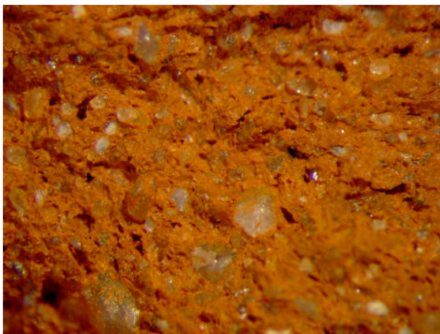
Figur G.46. Prøve F Sønderskov – reference 1025°C Brudflade – Forstørrelse 24x
