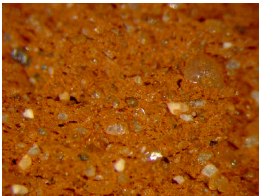
Figur G.36. Prøve E Sønderkov – glasmel 1000°C Brudflade – Forstørrelse 24x
