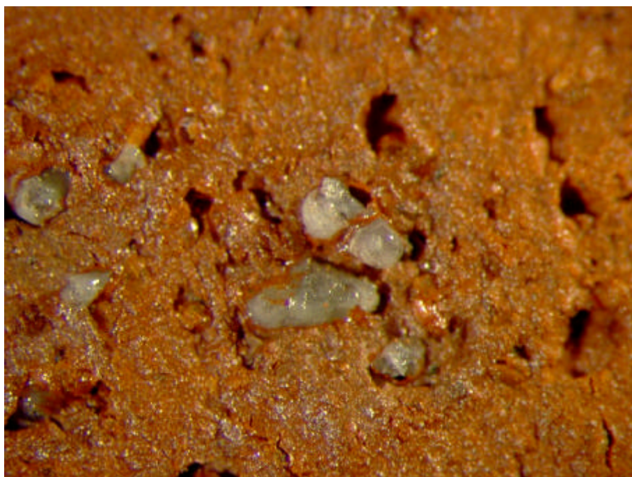
Figur G.29. Prøve D Sønderkov – glasmel 1025°C Synsflade – Forstørrelse 24x
