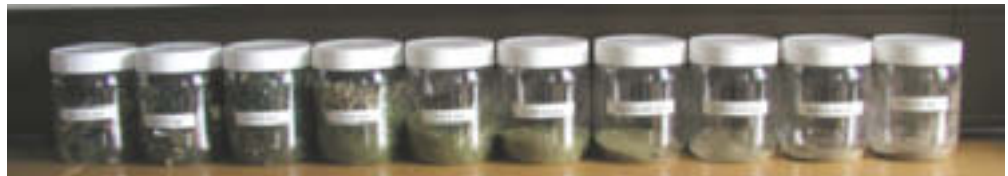
Figur 5.2: Sigterester for knust glas fra 16 - 31,5 mm (venstre) til 0 - 0,075 mm (højre).
