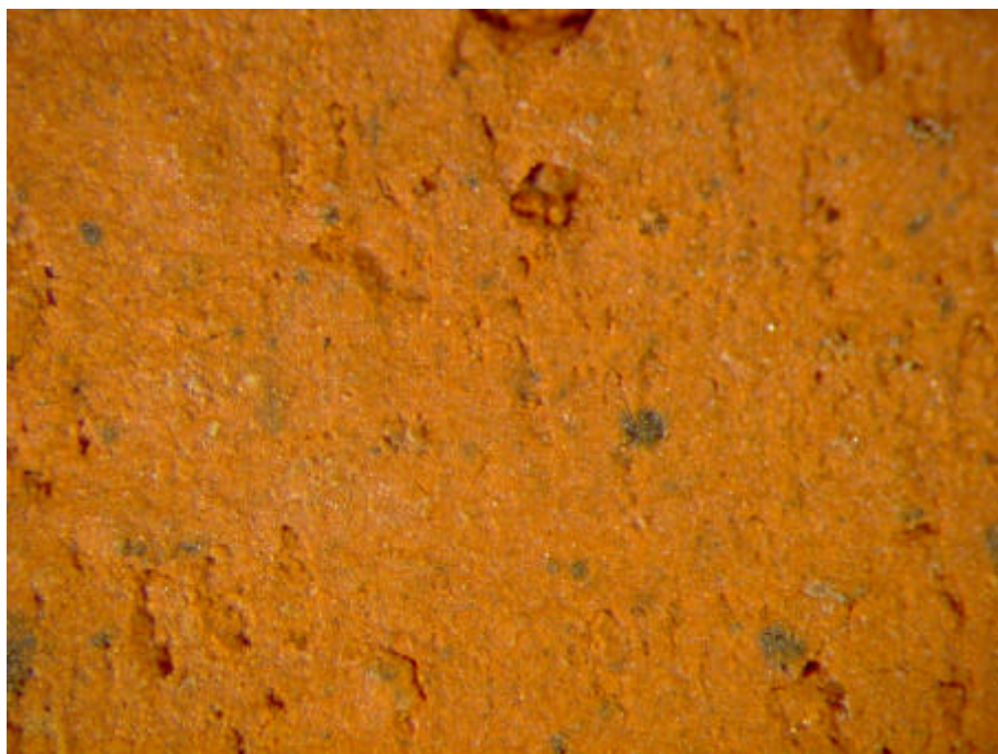
Figur G.19. Prøve C Hammershøj – reference 1000°C Synsflade – Forstørrelse 24x
