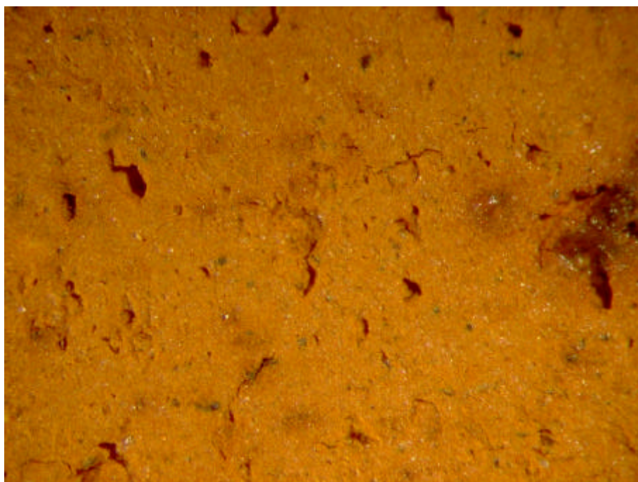
Figur G.25. Prøve D Sønderkov – glassand 975°C Synsflade – Forstørrelse 24x
