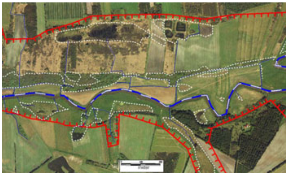
Figur 8.15. Ortofoto af delstrækning ved Navr Hede. På billedet ses Storåen (blå-hvid streg); grøfter på eng og marker (blå streg); ådalens afgrænsning (rød, savtakket streg); samt våde engzoner (hvid, prikket streg).
