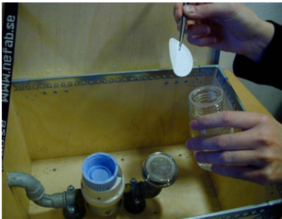
Figur 4 Efter fil trering skrues øverste del af fil treringsenheden af og fil ter placeres i bluecap flaske med steril t ledningsvand til opbevaring under transport til laboratoriet.
