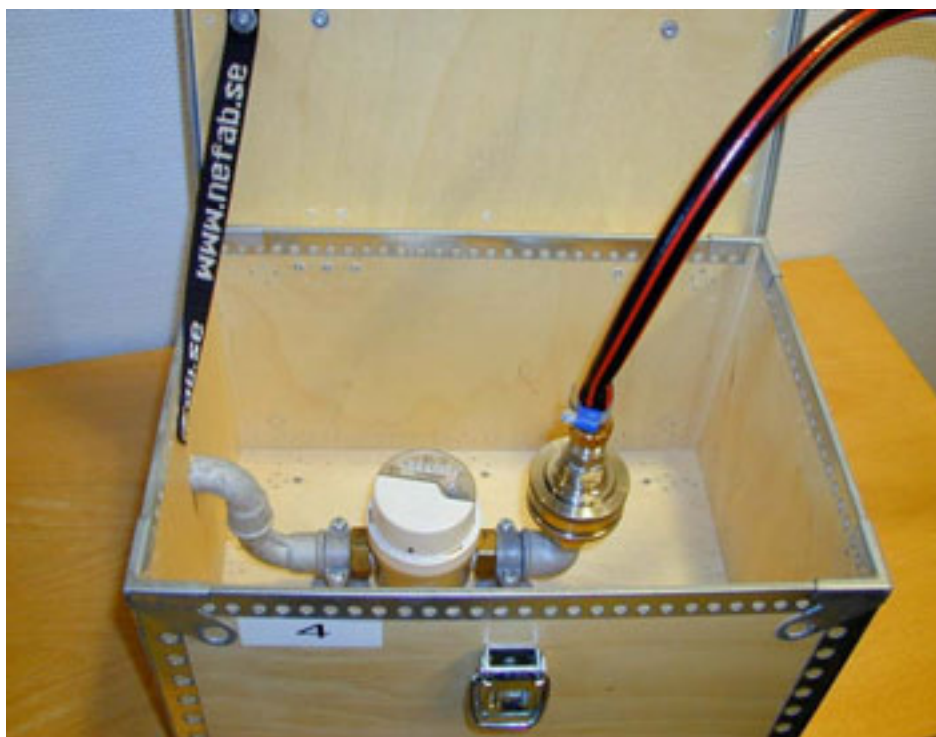
Figur 1 Prøvetagningsudstyret der er udviklet af Eurofins Danmark A/S. Fil treringsenheden er forbundet til et vandmåleur monteret samlet i en kasse.
