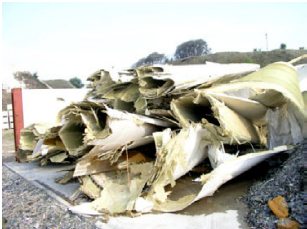
Figur 14 Foto af møllevinger klippet i stykker af ca. 4 meters længde før neddeling
