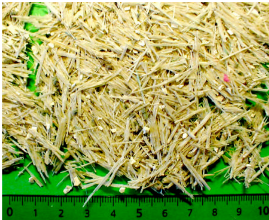
Figur 19 Foto af semifleksibel "mätte" bundet af løse fibre/fiberbundter fra møllevin-ge og fortyndet PVA-lim
