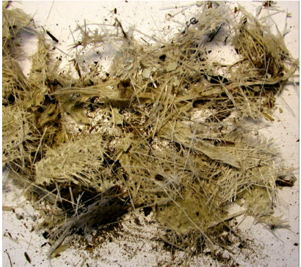
Figur 11 Foto af håndsorterede dele af neddelte materiale fra H.J. Hansen Genvindingsindustri: Fortrinsvis fiberdele, der er mere eller mindre dækket af plastmateriale
