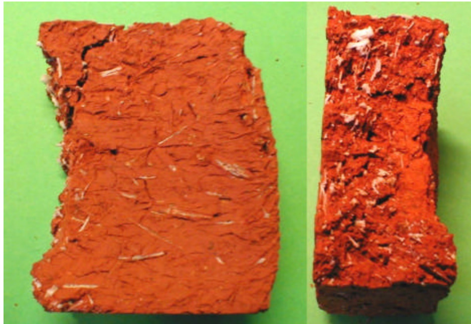
Figur 18 Foto af prøveemner: Minimursten efter sidste brænding ved 1000°C
