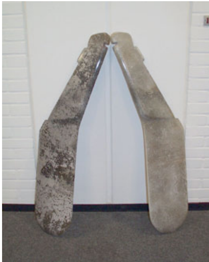
Figur 10 Rorplader til jolle; til venstre rorplade af ikke rensset regenerat, til højre rorplade af rensset regenerat. Dimensioner: Højde 108 cm, største bredde 26 cm, godstykkelse 5 mm
