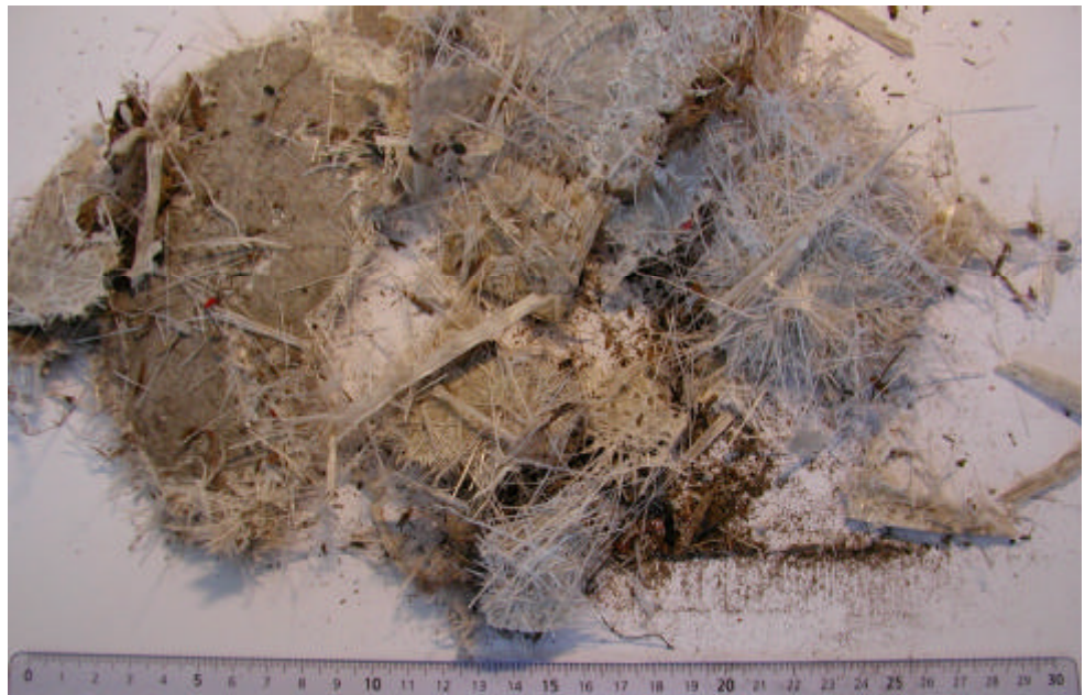
Figur 12 Foto af neddelte materiale fra H.J. Hansen Genvindingsindustri: Stykker på 5 - 20 cm, enkelte fiberdele, støv og diverse smuld
