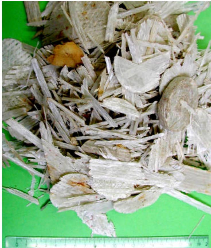
Figur 16 Foto af den nederste del af vingeroden, som var vanskelig at neddele pga. den kompakte karakter dvs. meget høje glasindhold
