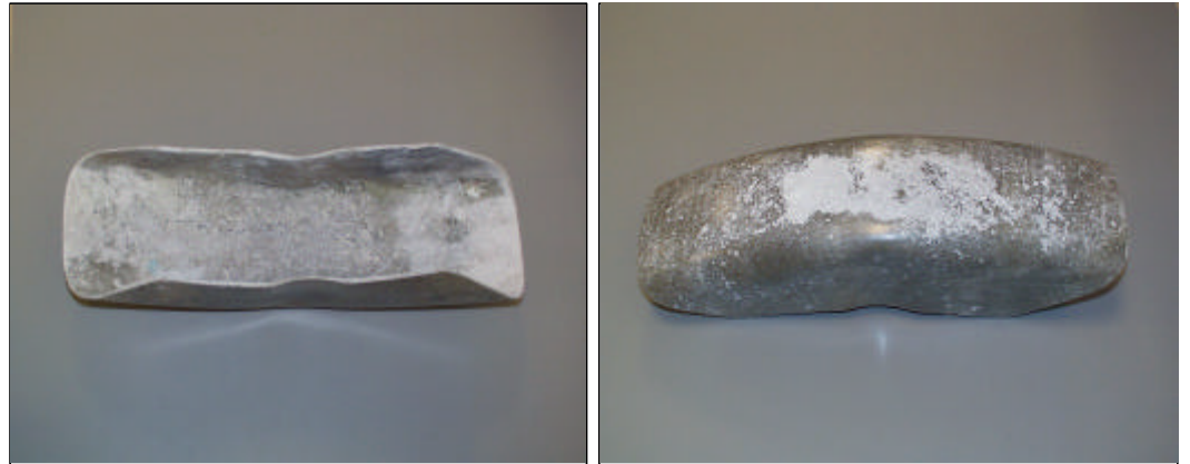
Figur 8 Motorcykelskærm af ikke rensset regenerat. Dimensioner: Længde 38 cm, bredde 11 cm, højde 9 cm, godstykkelse 4 mm
