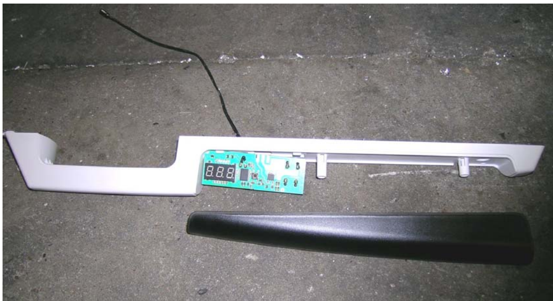
Foto 3.7: Montage af printkort i håndtag
