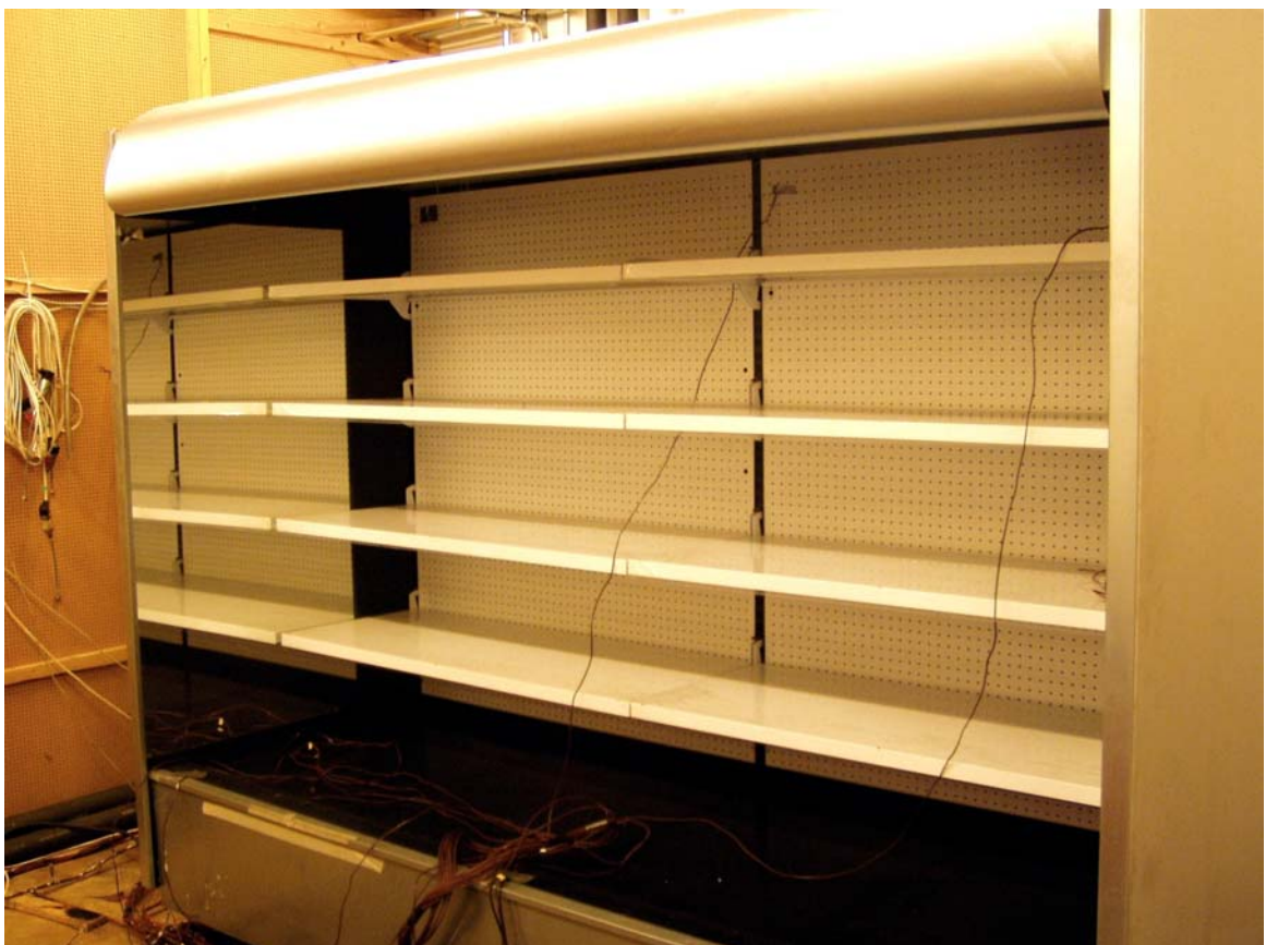
Foto 3.5: Foto af remote-kølereol placeret i klimakammer på Teknologisk Institut.
