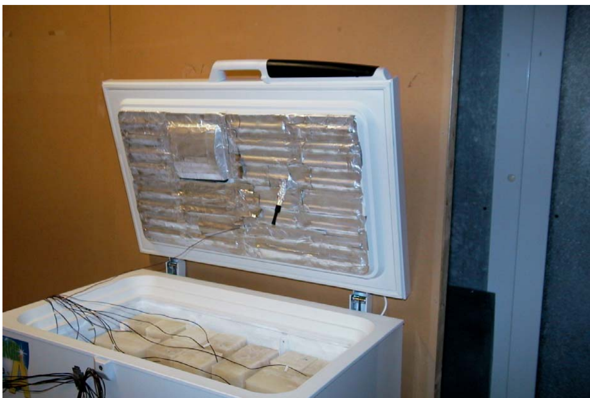
Foto 3.3: Test af kummefryser med blank underside. En blank underside reducerer varmetransmissionen igennem låget.
