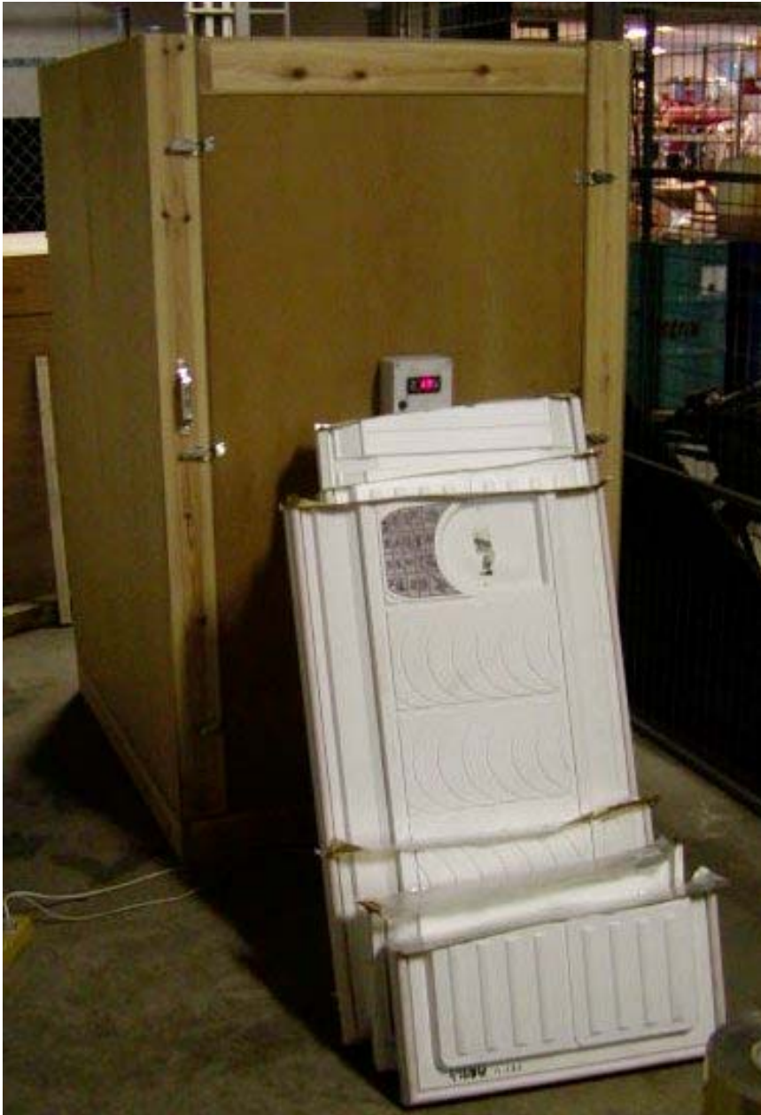
Foto 3.6: Ældningsskab (i baggrunden) og ældede låger, som er blevet forseglet og klar til transport til analyse af gassammensætning i cellegassen.
