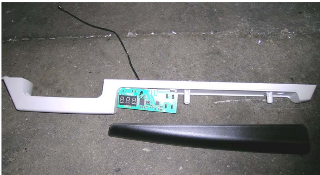
Foto A.2: Montage af printkort i håndtag
