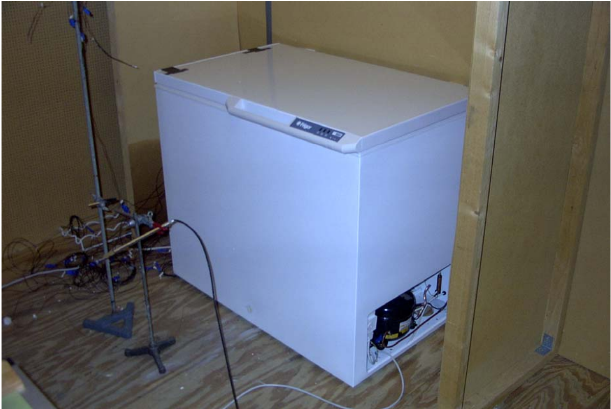
Foto 3.2: Frigor boks med VIP-paneler. Der er målt en reduktion i energiforbruget på ca. 17 % i forhold til en kumme uden VIP.
