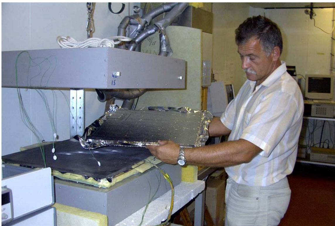
Foto 3.1: Et vakuumisoleringspanel placeres i en "lambda-maskine" på Teknologisk Institut
