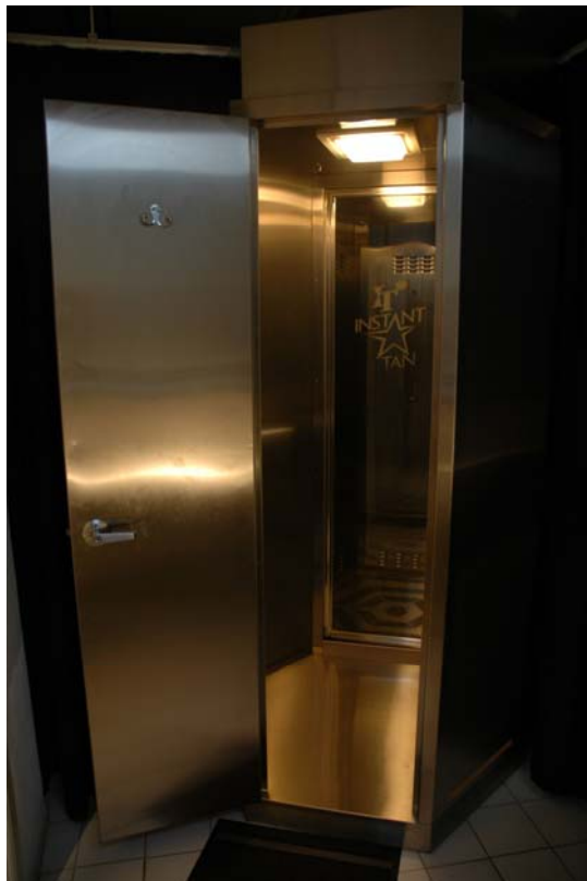
Lukket kabine til autospray. Forrummet til at hænge sin kimono i er adskilt fra sleeve sprøjtekabinen med en dør.
