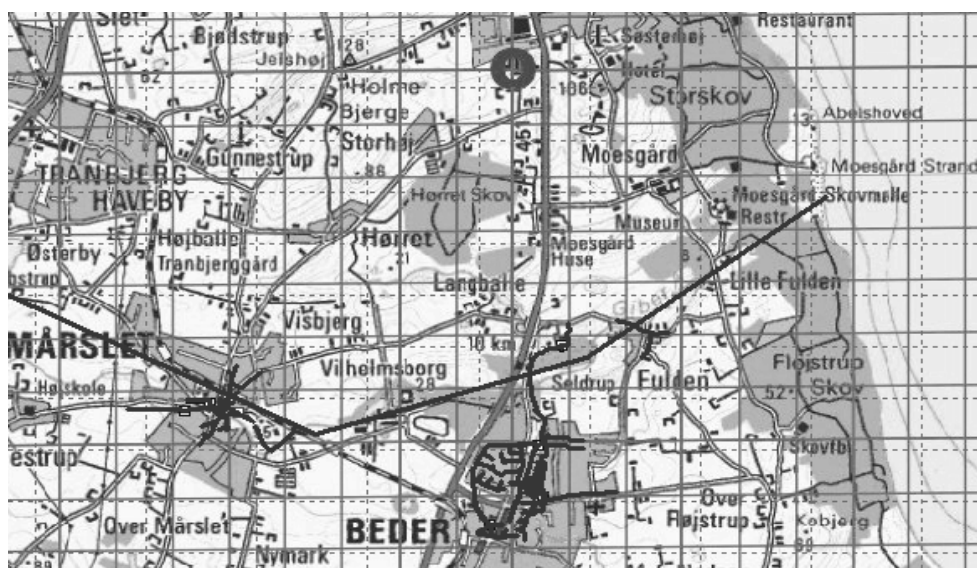
Figur 3.2 MOUSE model I'en for kloaksystemerne i Giber Å's opland. Byerne Tranbjerg (delvis uden for figuren), Mårslet og Beder er inkluderet i model I'en sammen med Giber Å. Model opsætningen er vist med den sorte linie.
