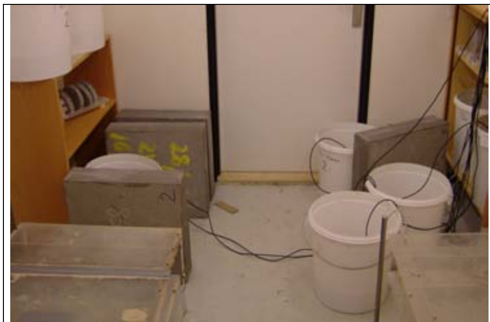
Figur 5.1 Foto af klimakammer med spande og letklinkerbetonfliser. Ledningerne fører fra fugtfølerne placeret i prøveemnernes midte til datalogger, hvor signalet opsamles kontinuert.
