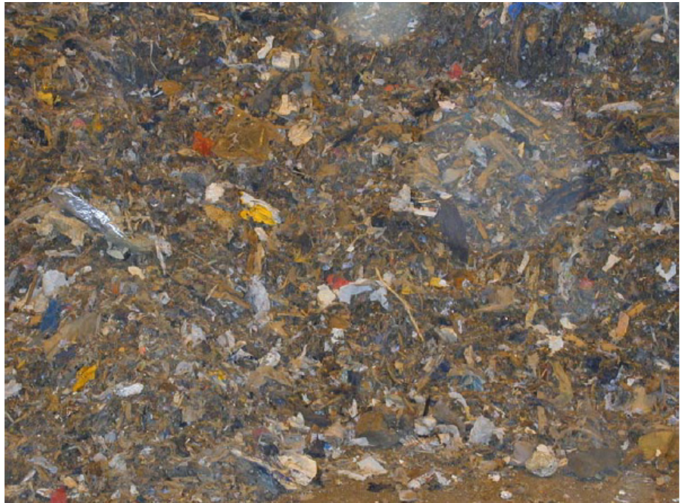
Figur 5. Fluid bed kedlens hovedbrændsel (ca. 85%), "Returflis", som er neddelte nedrivningsaffald mm.
