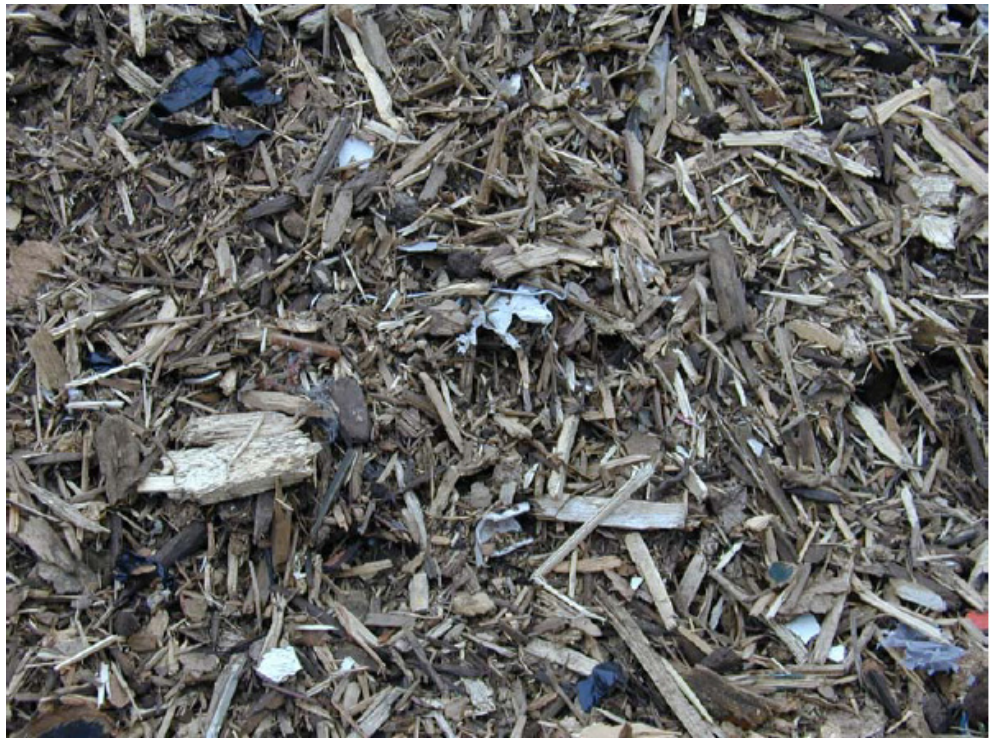
Figur 4. Neddel t bygningsaffald som til føres CFB anlægget (detaljer).
