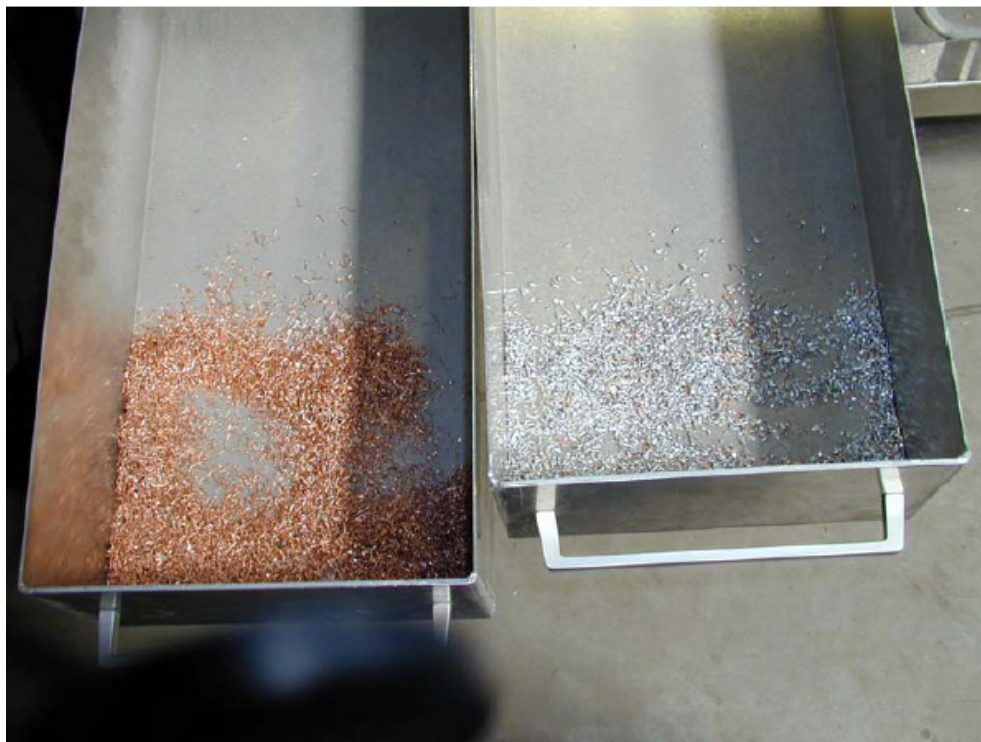
Figur 3. Udsorterede produkter (Cu og Al) fra Metal "X" SpectraSense. Tilfældig test-kørsel.
