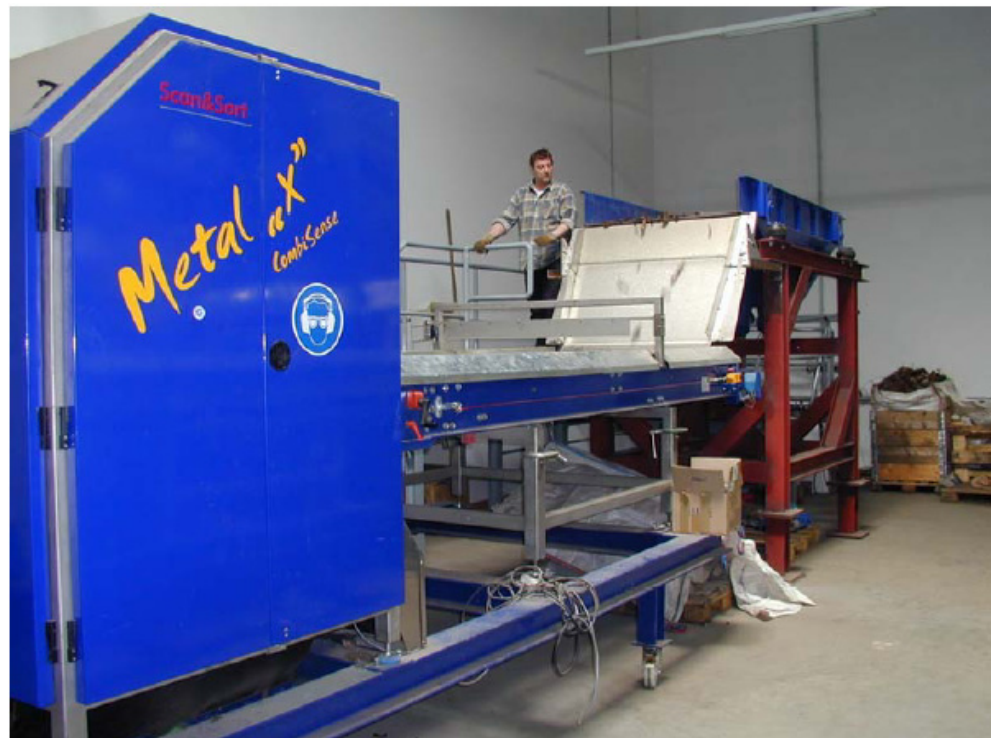
Figur 2. SSE's demonstrationsanlæg: Metal "X" CombiSense. Indføddingen sker manuelt øverst til højre på rysterenden.
