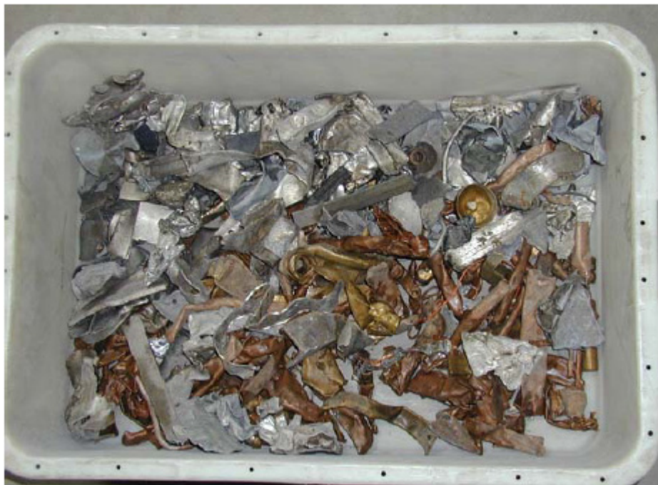
Figur 5. Demonstration 2: Input: Blanding af messing/kobber-skrot og gråt metal - ca. 2-20 cm.
