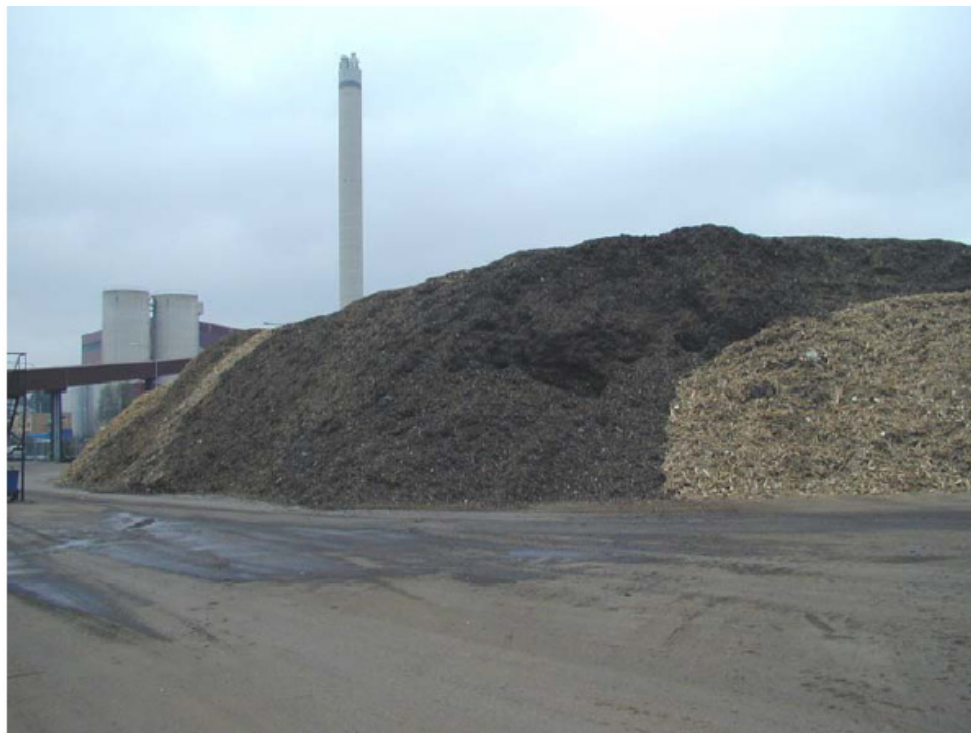
Figur 3 Neddelte bygningsaffald som tilføres CFB anlægget (Iagerkapacitet)
