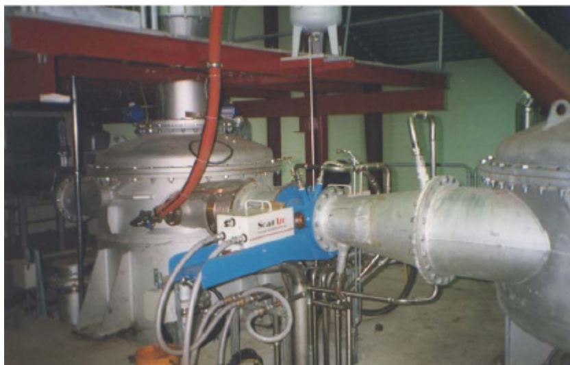
Figur 4. Top af forgasser med plasmagenerator (blå).
