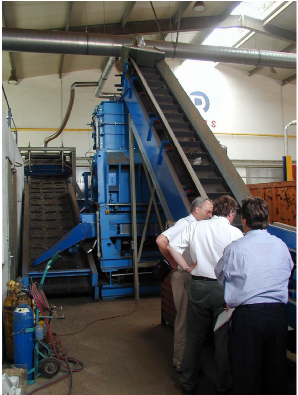
Figur 2. Granulator (mølle) med tilførsel af friskt shredderaffald (th.)og udgående strøm (tv.).
