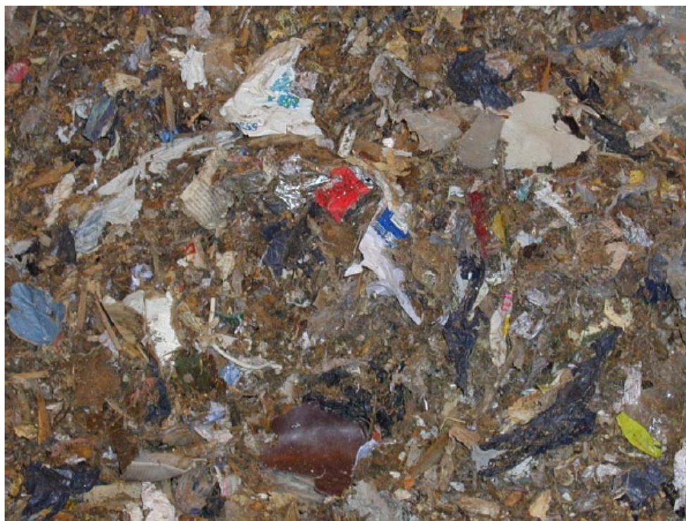
Figur 6. Nærbillede af "Retur-flis", som indeholder store mængder papir, spånplader, malet træ, metaller og plast (efter sigende uden PVC).
