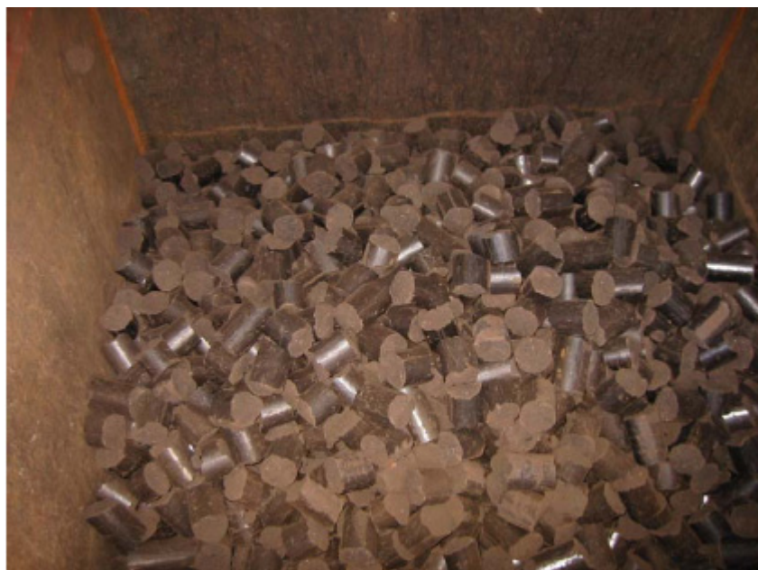
Figur 5. brændselsspillerne til Borges Pyroarc-anlæg er ca. 50 mm i diameter.
