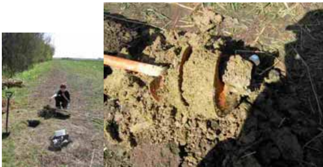
FIGUR 2.1 SNEGLEBOR MONTERET FORLÆNGERSTÆNGER. BILLEDET TIL HØJRE VISER JORDPRØVE PÅ SNEGLEBOR. MODIFICERET FRA ALMINDELIGT PÆLEBOR AF OLE STIG JACOBSEN, GEUS.
