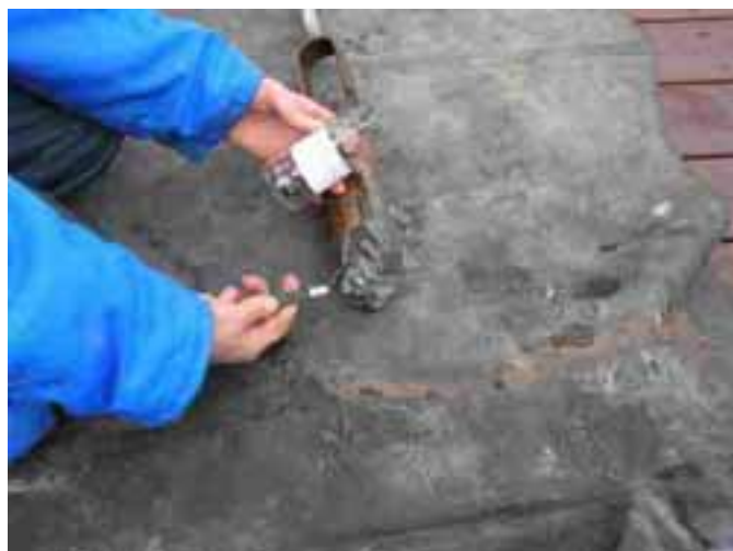
FIGUR 2.4 PRØVETAGER UDVIKLET TIL UDTAGNING AF SEDIMENTPRØVER FRA BUNDEN AF TO BRØNDE.
