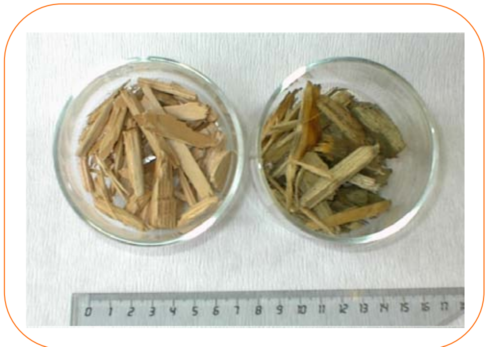
Figur 9: Trykimprægneret affaldstræ før (højre) og efter (venstre) behandling.
