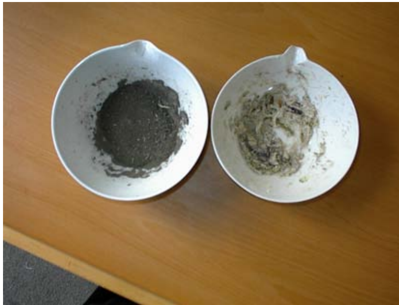
Figur 13: Aske fra hhv. ubehandlet CCA affaldstrø (venstre) og fra Watech behandlet affaldstrø (højre).
