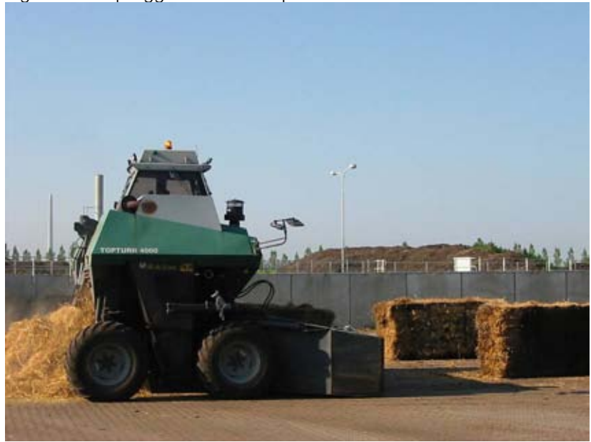
Figur 9: Halmen køres igennem af milevender så der bliver to "små" halmmiler
