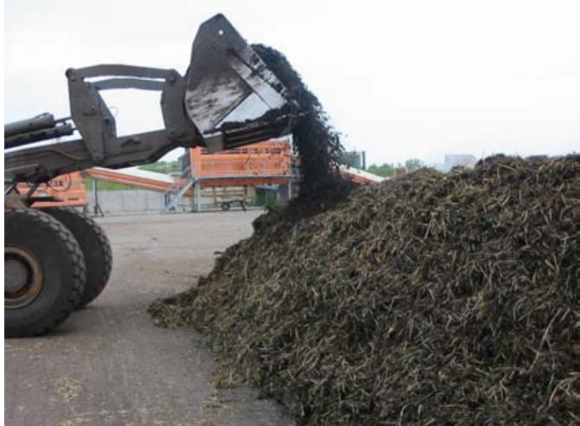
Figur 15: Toppen af milen dækkes med 1 m 3 sigterest pr 2 m
