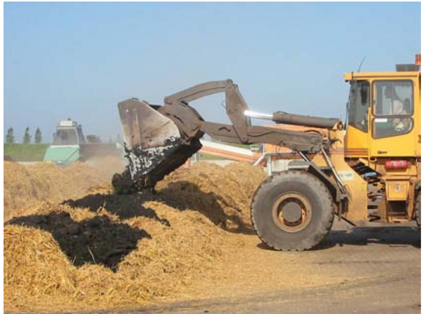
Figur 10: 1,5 m 3 spildevandsslam fra rensningsanlæg lægges i halmmilerne pr 2 m mile
