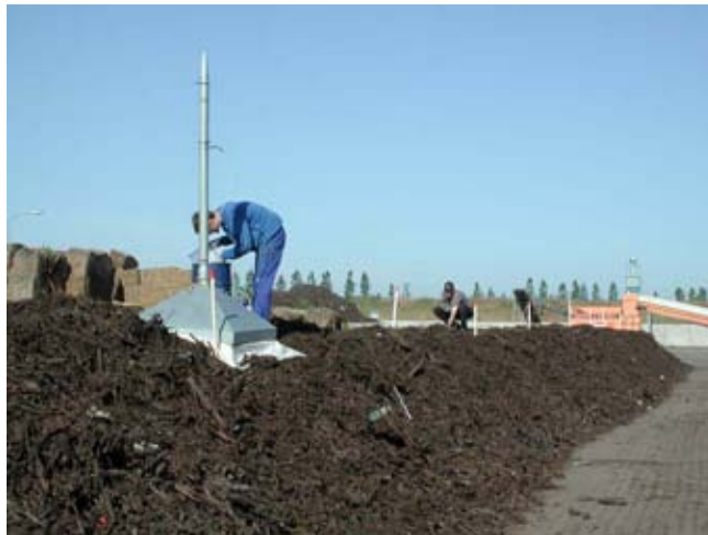
Figur18: Udtagning af lugtprøver samt monitoring af milen
