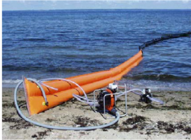
Figur 5: Strandflydespærring forbundet med kystspærring
