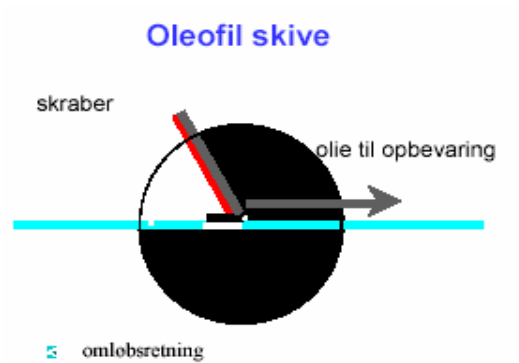
Figur 12: Princippet i en skiveskimmer
