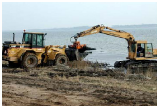
Figur 17: Entreprenørmaskiner anvendes til at samle olie op
