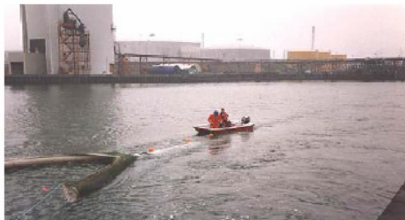
Figur 16: Oliecrawl, trawlposen med opsamlet olie er ved at blive frigjort
