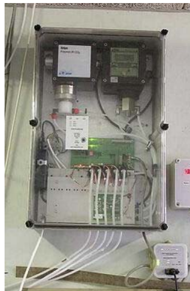
Figur 3. Kontinuerlige ammoniak og kuldioxidmålinger kan foretages med VE 18 Multisensor fra VengSystem. I hver sektion placeres en pumpe ved udsugningsenheden, der pumper 1-2 liter luft pr. minut til VE 18 Multisensor placeret. I VE 18 er der et ventilarrangement, så der kan skiftes mellem luftprøver fra for eksempel fem kanaler, hvoraf den ene kanal bruges til udeluft som reference, mens de fire andre måler på de enkelte staldsektioner. Luftprøverne blev herefter analyseret for koncentrationen af ammoniak og kuldioxid. Udstyret indstilles således, at der måles skiftevis 10 minutter på udeluft og 10 minutter på stalduft. I slutningen af hver måleperiode, umiddelbart før der skiftes kanal, lagres en måleværdi. Systemet anvender en elektrokemisk ammoniaksensor af fabrikatet Dräger Polytron I. Ammoniaksensoren kræver et system, hvor der hele tiden skiftes mellem udeluft og stalduft. Sensoren har en vis krydsfølsomhed over for blandt andet kuldioxid og er uegnet ved ammoniakkoncentrationer under 1-2 ppm og derfor ikke egnet til måling efter luftrenser. Der skal løbende foretages kontrolmålinger med for eksempel Kitagawarør.
