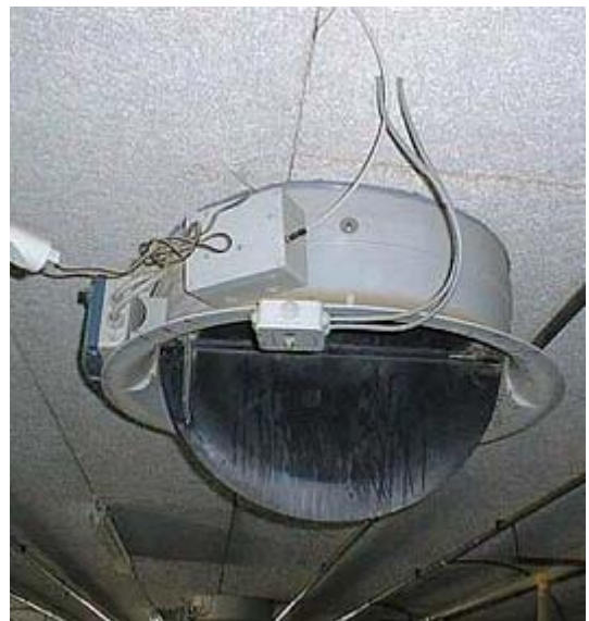
Figur 3. Kontinuerlige ammoniak og kuldioxidmålinger kan foretages med VE 18 Multisensor fra VengSystem. I hver sektion placeres en pumpe ved udsugningsenheden, der pumper 1-2 liter luft pr. minut til VE 18 Multisensor placeret. I VE 18 er der et ventilarrangement, så der kan skiftes mellem luftprøver fra for eksempel fem kanaler, hvoraf den ene kanal bruges til udeluft som reference, mens de fire andre måler på de enkelte staldsektioner. Luftprøverne blev herefter analyseret for koncentrationen af ammoniak og kuldioxid. Udstyret indstilles således, at der måles skiftevis 10 minutter på udeluft og 10 minutter på stalduft. I slutningen af hver måleperiode, umiddelbart før der skiftes kanal, lagres en måleværdi. Systemet anvender en elektrokemisk ammoniaksensor af fabrikatet Dräger Polytron I. Ammoniaksensoren kræver et system, hvor der hele tiden skiftes mellem udeluft og stalduft. Sensoren har en vis krydsfølsomhed over for blandt andet kuldioxid og er uegnet ved ammoniakkoncentrationer under 1-2 ppm og derfor ikke egnet til måling efter luftrenser. Der skal løbende foretages kontrolmålinger med for eksempel Kitagawarør.
