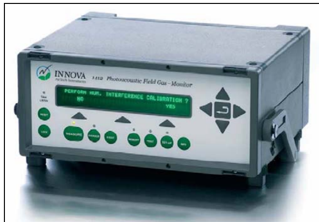
Figur 5. Kontinuerlig måling af ammoniak og eventuelt op til i alt fem gasser kan foretages med et måleinstrument fra Innova. Dermed kan der måles samtidigt for både ammoniak, \text{CO}_2 og eventuelt drivhusgasser i situationer, hvor det er relevant. Måleinstrumentet kan anvendes til både kontinuerlige målinger i stalde samt før/efter luftrensere. Ud over den viste måler skal systemet udbygges med slanger, pumper, filtre, ventilarrangement, kondenssikring m.m., før man har et komplet måleudstyr. De kontinuerlige elektroniske målinger bør løbende kontrolleres med sporgasmålinger.
