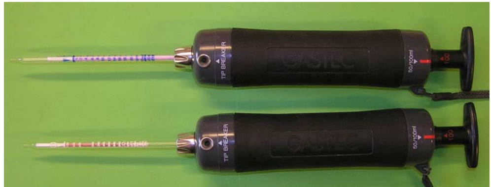
Figur 4. Måling af ammoniak- og kuldioxidkoncentration kan foretages med sporgasrør. På billedet er der vist pumper af fabrikatet Gastec samt ammoniak- og kuldioxidrør af fabrikatet Kitagawa. Ammoniakmåling ved sporgasrør sker ved en kemisk reaktion. I for eksempel ammoniakrøret Kitagawa 105SD er det en reaktion af ammoniak med fosforsyre. Da det er en 1:1 kemisk reaktion, og der i staldluft ikke i nævneværdig grad er krydsfølsomhed overfor andre gasser, kan man lave en meget præcis måling ned til detektionsgrænsen på 0,2 ppm. Sporgasrør er derfor velegnede til at måle efter luftrensere og til at kontrollere elektronisk måleudstyr.
