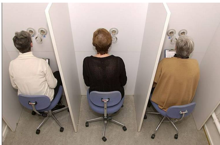
Figur 1. Lugtmålinger udføres ved, at der over en periode på 30 minutter fyldes en 30 liter teflon pose med luft. Før lugtprøven konditioneres posen ved at fylde og efterfølgende tømme den for staldluft. Teflonposen fyldes indirekte ved at suge luft ud fra den beholder, der omgiver posen. Efterfølgende skal poserne transporteres til et lugtlaboratorium, hvor prøverne analyseres olfaktometrisk. I olfaktometer fortyndes lugtprøverne.
