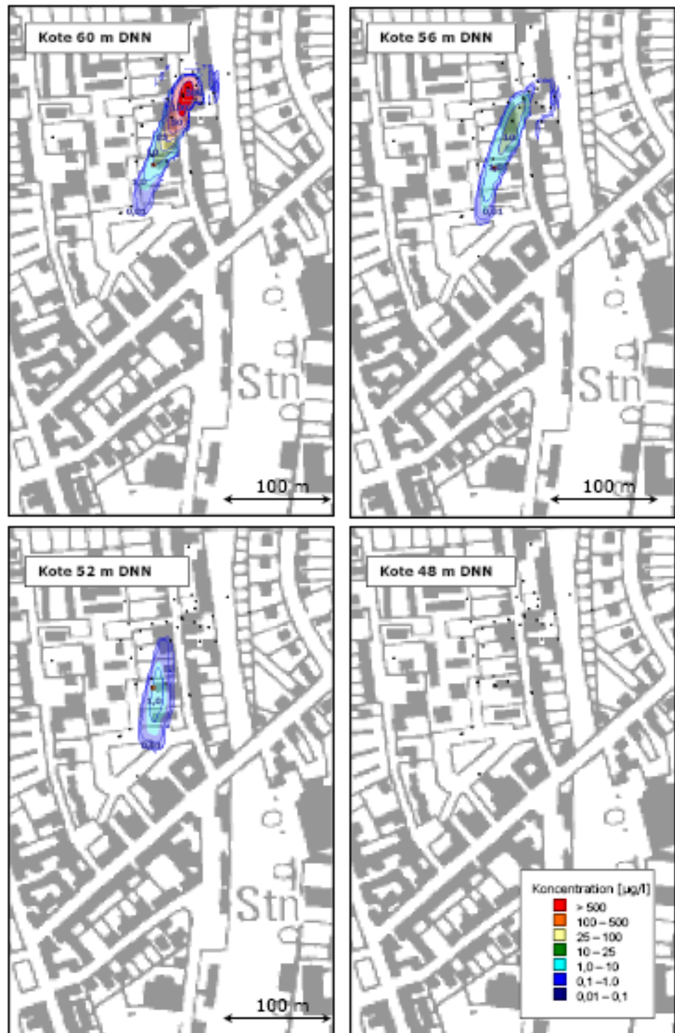
Figur 7.4: Simuleret udbredelse af 2,6-xylenol (scenarie 2) ved nedbrydning i alle zoner, fra /6/. Parametervalg: Tilførsel af stof: 2,3 kg/år; T_{1/2} , [Fe ++ (fane)] = 50 d; T_{1/2} , [Fe ++ ] = 8 d; T_{1/2} , [NO 3 ] = 8 d.
