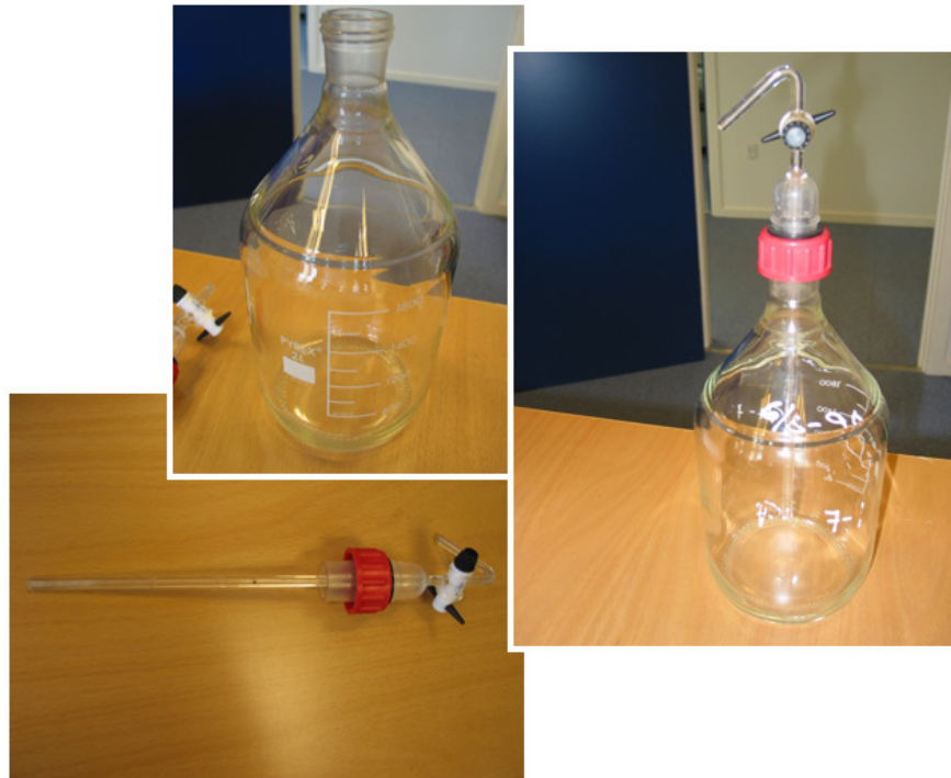
Figur 6.2 Eksempel på de testflasker der blev anvendt til de anaerobe nedbrydningsforsøg, fra /5/.
