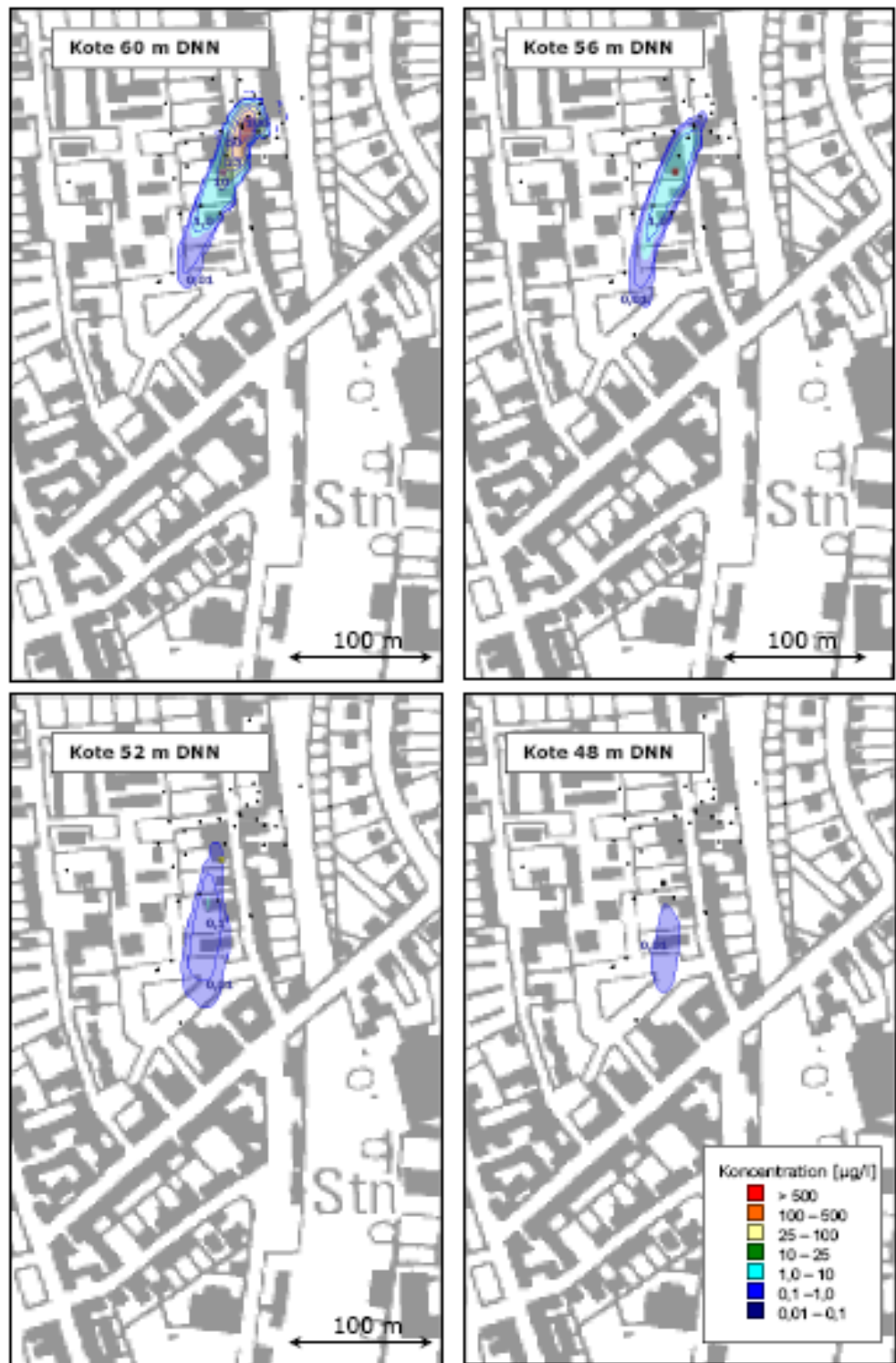
Figur 7.5: Simuleret udbredelse af benzothiophen (scenarie 3) med nedbrydning i alle zoner, fra /6/. Parametervalg: Tilførsel af stof: 0,2 kg/år; T_{1/2} , [\text{Fe}^{++}(\text{fane})] = 69 d; T_{1/2} , [\text{Fe}^{++}] = 19 d; T_{1/2} , [\text{NO}_3^-] = 2 d.
