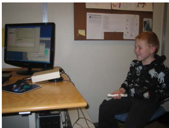
Figur 2.6. Undersøgelsessituation af reaktionstidsmåling. Barnet trykker på en sensorknap hurtigst muligt efter at barnet hører en bip-lyd.
